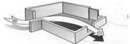
ΧΡΗΣΗ ΠΑΡΑΘΥΡΩΝ ΜΕ ΕΞΟΦΥΛΑΑ ΓΙΑ ΚΑΘΟΔΗΤΗΣΗ ΤΟΥ ΑΕΡΑ ΜΕΣΑ ΣΤΟ ΧΩΡΟ
