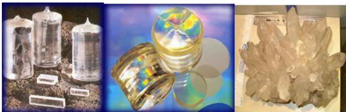
Σχήμα 3.6: Κρύσταλλοι πιεζοηλεκτρικών υλικών όπως απαντώνται στην φύση .Στα αριστερά κρύσταλλοι LiTaO_3 , στο κέντρο κρύσταλλοι LiNbO_3 , ενώ δεξιά κρύσταλλοι χαλαζία.
