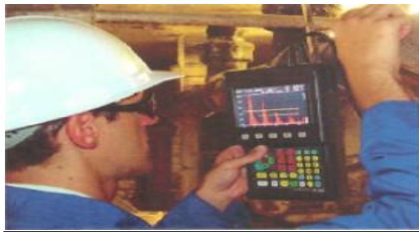
Σχήμα: Μέθοδος των υπερήχων. [πηγή:2]
