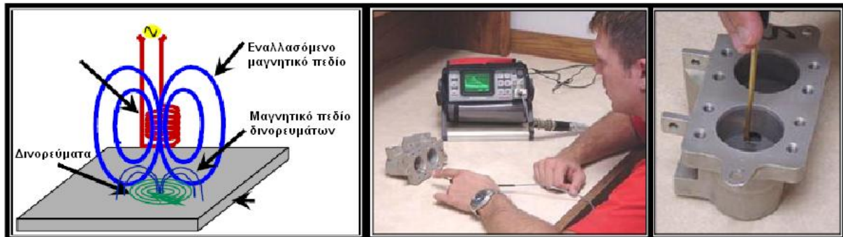
Σχήμα: Μέθοδος των δινορευμάτων. [πηγή:6]
