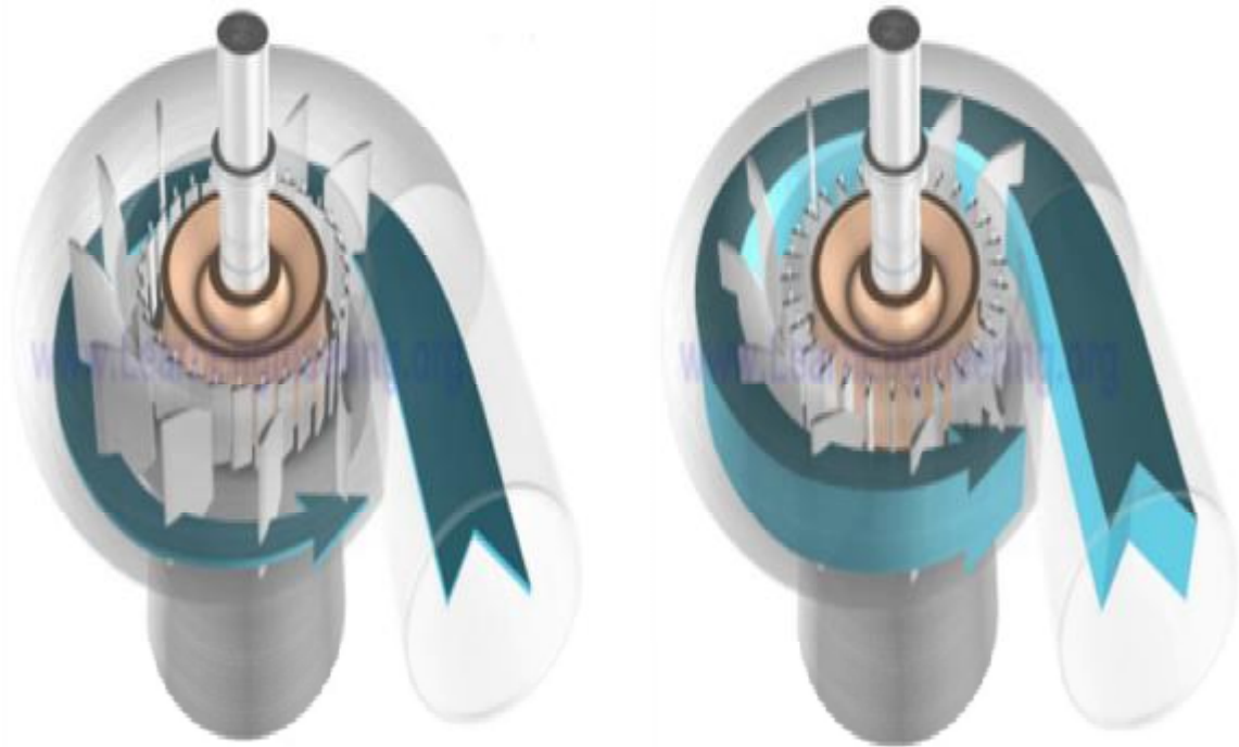
Εικόνα 4.4 Σπειροειδές κέλυφος ,έλεγχος συστροφής νερού
