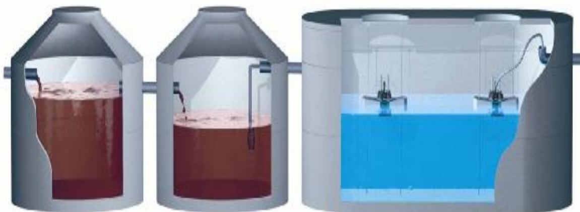
Εικόνα 4.2: Δεξαμενή Εναλλασσομένων Λειτουργιών Διαλείποντος Έργου (Sequencing Batch Reactor, SBR) ( www.enya.gr )
