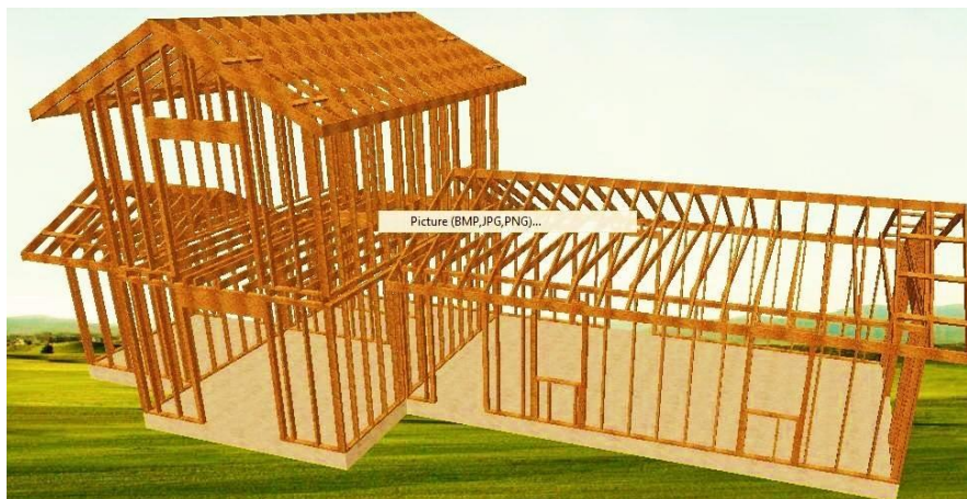
Εικόνα 4.3: Ακριβής τρισδιάστατη απεικόνιση του ξύλινου σκελετού της κατοικίας.
