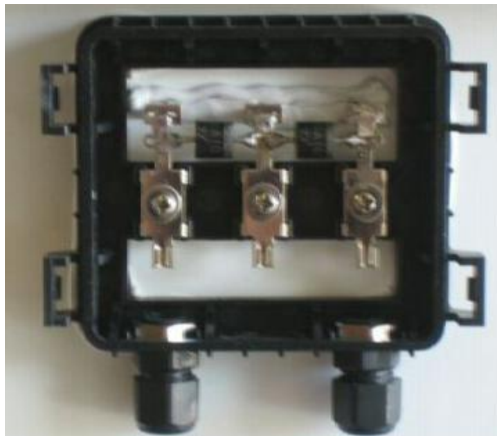
Εικόνα 4.4: Δίοδοι BYPASS στο πίσω μέρος ενός PV πλαισίου [Από εργαστήριο ΑΠΕ].
