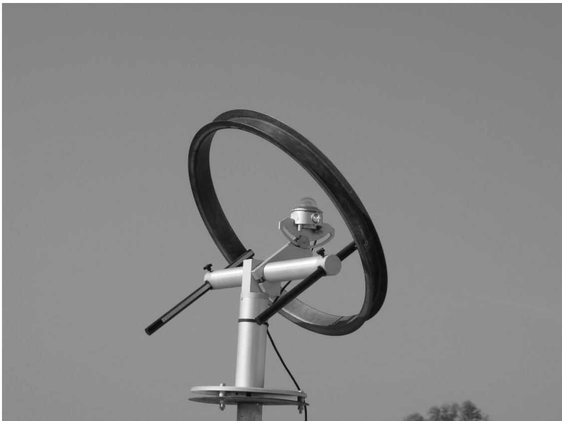
Εικόνα 5.9: Πυρανόμετρο με στεφάνη για την μέτρηση διάχυτης ηλιακής ακτινοβολίας στο οριζόντιο επίπεδο, εγκατεστημένο στο εργαστήριο ΑΠΕ.
