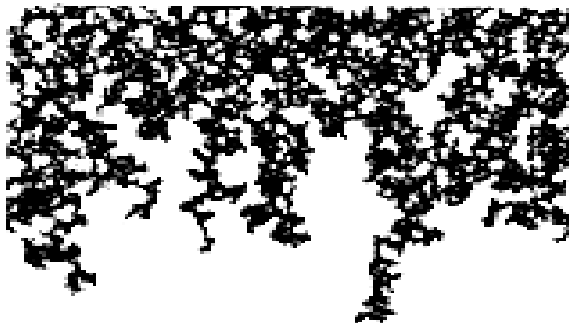
Σχήμα 2.5.(b): Μη αναμίξιμη εκτόπιση υδατικής (άσπρο) από μη υδατική φάση (μαύρο) Σχηματισμός τριχοειδών δακτύλων (capillary fingering).
