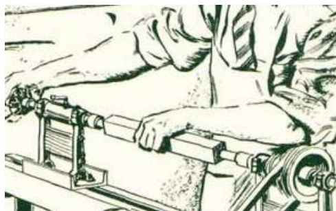
Εικόνα 5.1: Απεικόνιση στήριξης ξύλινης δοκού, σε τόρνο κατεργασίας ξύλου.
