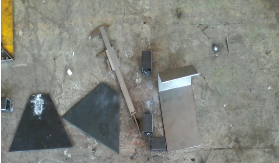
Εικόνα 4.7: Τεμάχια (12) με το σημάδι, για την διάνοιξη οπής των 12 (mm) και τεμάχιο (5).
