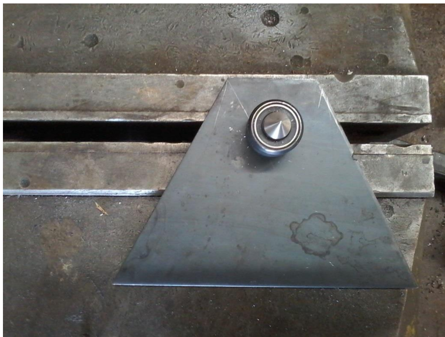
Εικόνα 4.8: Εφαρμογή της πόντας στο τεμάχιο (12).
