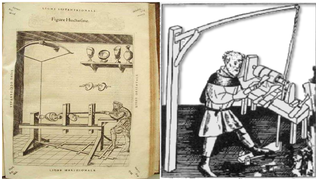
Εικόνα 2: Τρόπος παροχής της αμψίσημης περιστροφικής κίνησης, σε τόρνο μέχρι και τον 14 ο αιώνα.
