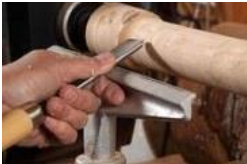
Εικόνα 5.3: Μέθοδος συγκράτησης κοπτικού εργαλείου, σε τόρνο ξύλου.
