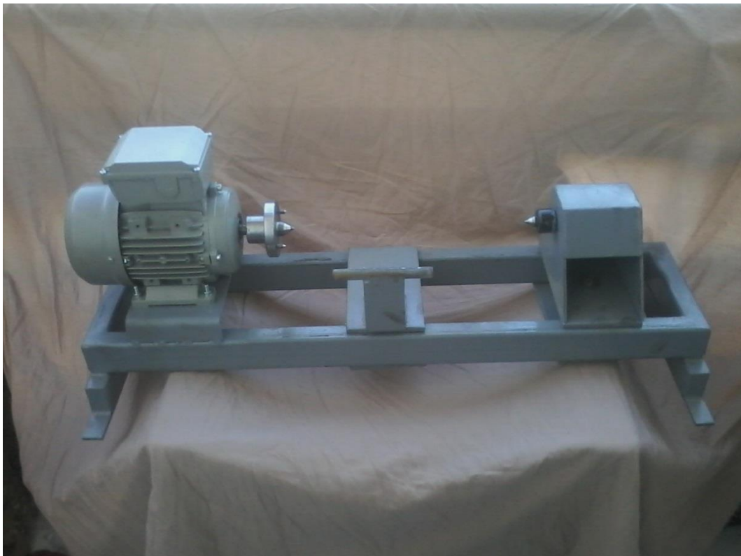
Εικόνα 4.10: Ο επιτραπέζιος συμβατικός τόνος, κατεργασίας ξύλου, μετά την συναρμολόγηση.
