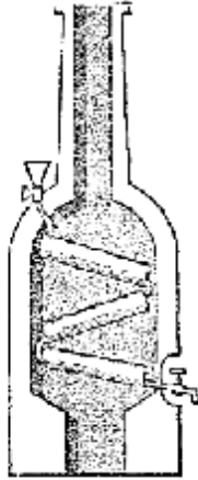
Σχήμα 3: Υδραυλωτός λέβητας του Blakey κατασκευής 1766. (Κων. Χ. Λέφας, Θεωρία Τεχνική και Οικονομία της θερμότητας )
