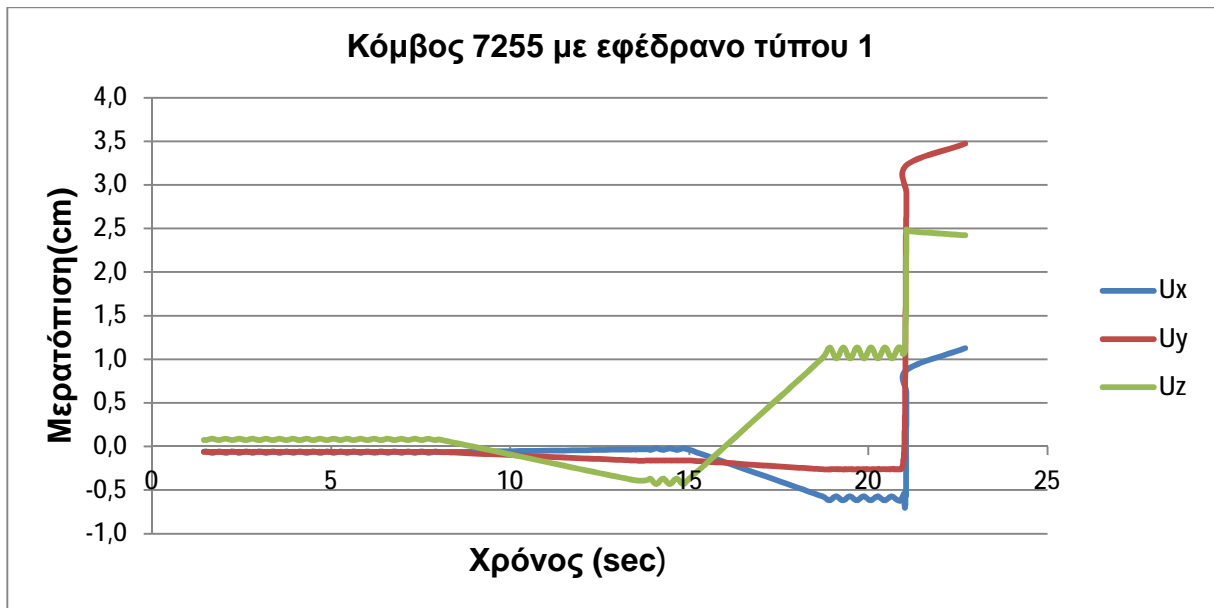
Σχήμα 6.6: Μετατοπίσεις του κόμβου 7255 στον κίονα με εφέδρανο τύπου 1
