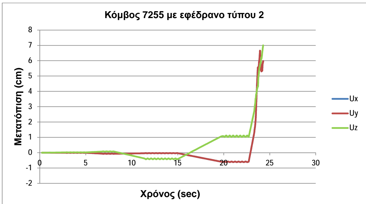
Σχήμα 6.7: Μετατοπίσεις του κόμβου 7255 στον κίονα με εφέδρανο τύπου 2
