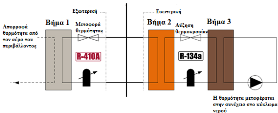
Εικόνα 3-15: Σύστημα των αντλιών θερμότητας (τεχνολογία cascade Daikin altherma) ( http://www.idealklima.gr/proionta/τεχνικά_χαρακτηριστικά )
