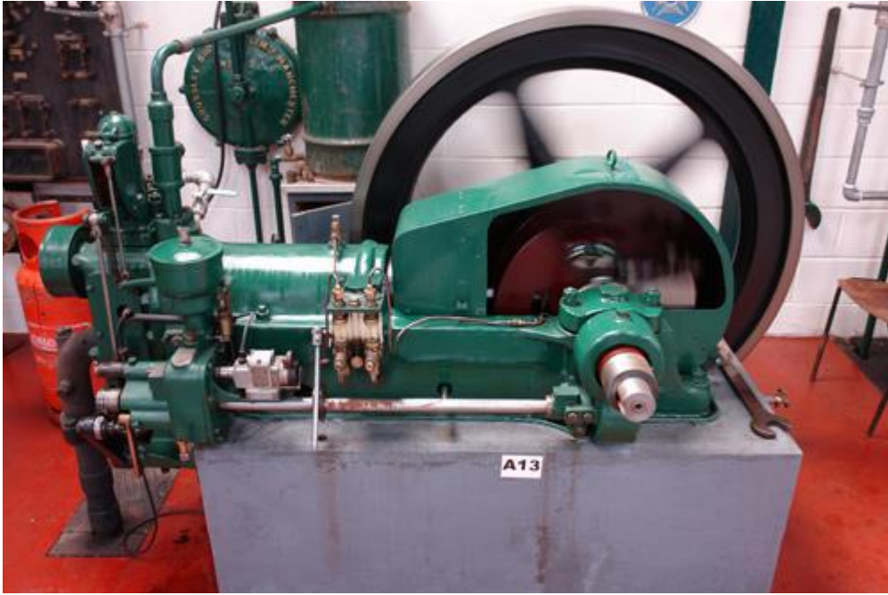
Εικόνα 2.3: τετράχρονη μηχανή Otto
