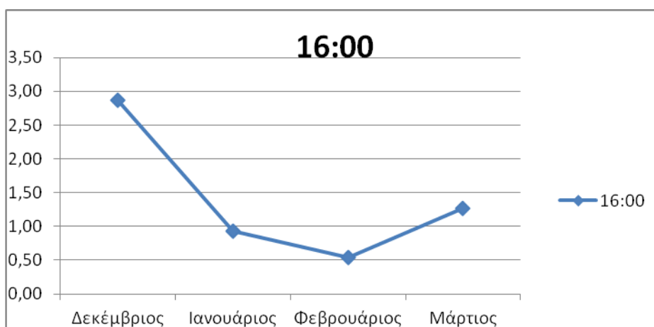
Διάγραμμα 4.3 (β): Συγκριτικό διάγραμμα διαφοράς μέσης μηνιαίας θερμοκρασίας (εσωτερικής – εξωτερικής) για τους χειμερινούς μήνες με ώρα μετρήσεις 16:00.
