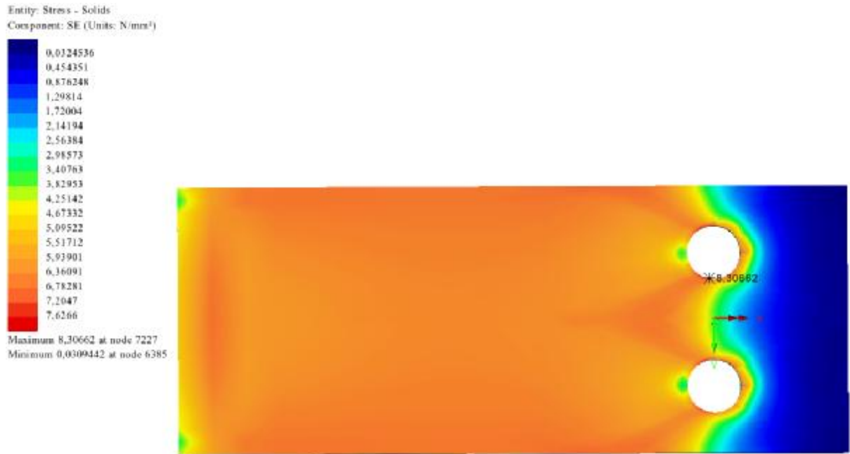
Σχήμα 4.14: Παρατηρούμενη μέγιστη τάση von Mises σε όλο το σύστημα
