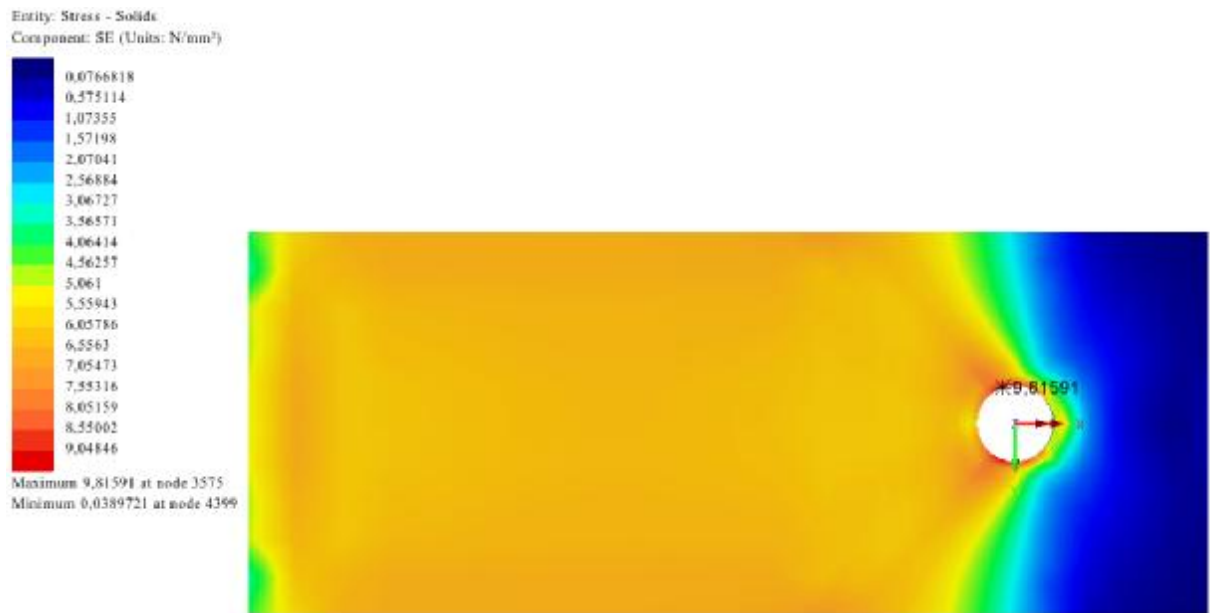
Σχήμα 4.6: Παρατηρούμενη μέγιστη τάσης von Mises σε όλο το σύστημα
