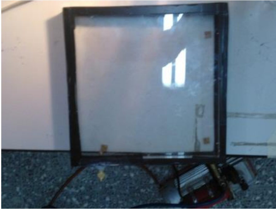
Εικόνα 4.11: Πάνελ διπλού υαλοπίνακα με υποπίεση
