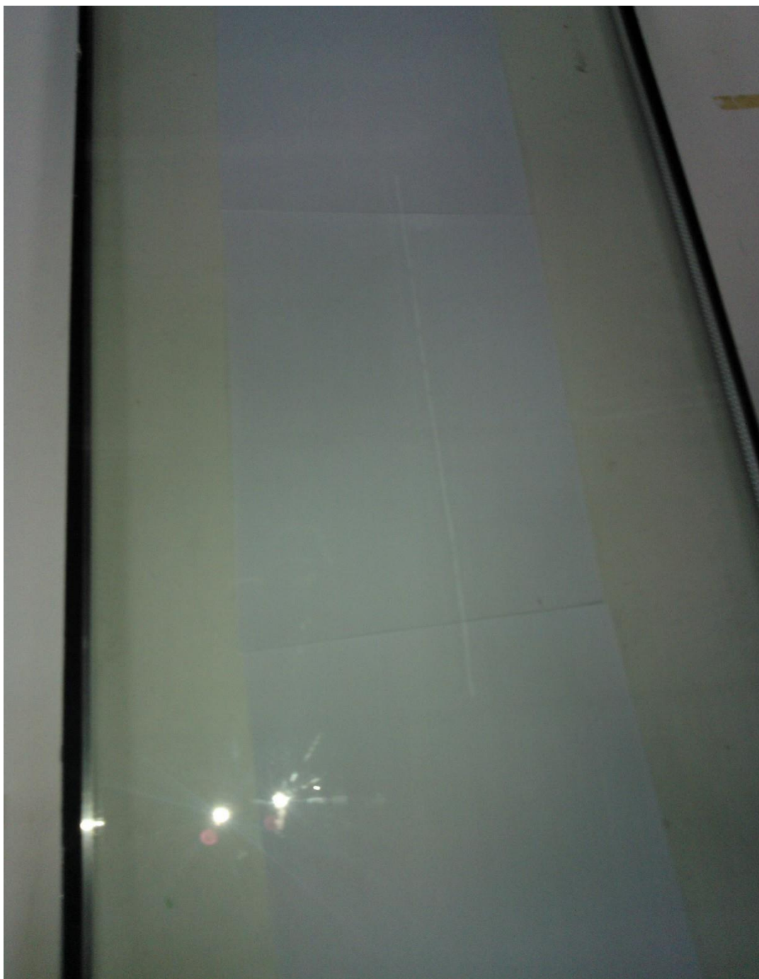
Εικόνα 4.8 Εμφάνιση γραμμής στο μέσο του πάνελ.
