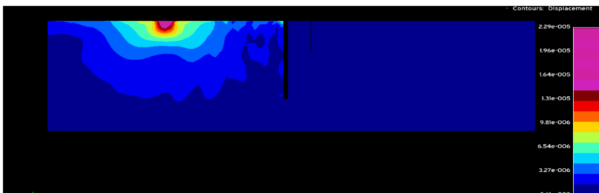
Εικόνα 4.6.26: Περίγραμμα μετατοπίσεων για συχνότητα αρμονικής δύναμης f = 100\text{Hz} με βάθος ορύγματος h = 10\text{m} , μήκος ορύγματος c = 0,5\text{m} και μήκος στοιχείων l = 0,7\text{m}
