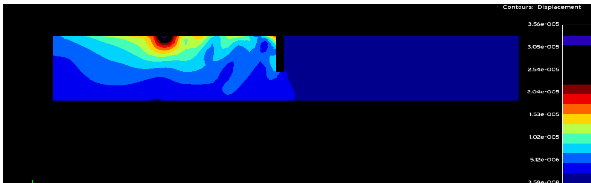
Εικόνα 4.4.13: Περίγραμμα μετατοπίσεων για συχνότητα αρμονικής δύναμης f = 50\text{Hz} με βάθος ορύγματος h = 2,5\text{m} και μήκος ορύγματος c = 0,75\text{m}
