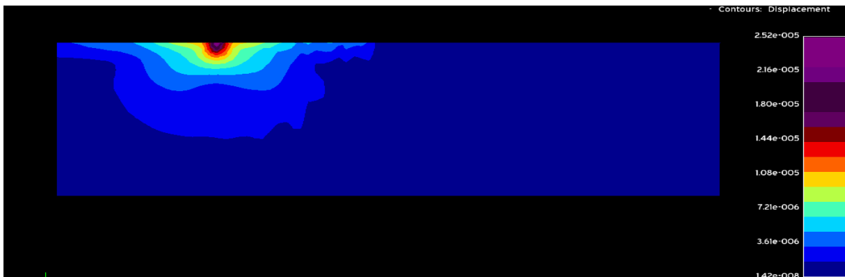
Εικόνα 4.6.43: Περίγραμμα μετατοπίσεων για συχνότητα αρμονικής δύναμης f=100\text{Hz} με βάθος επικαλυμμένου με σκυρόδεμα ορύγματος h=10\text{m} και μήκος ορύγματος c=0,5\text{m}
