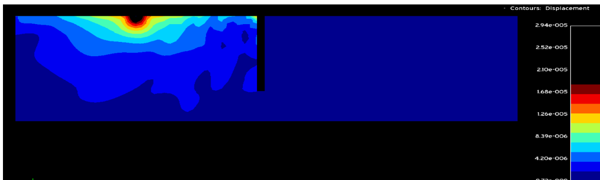
Εικόνα 4.5.15: Περίγραμμα μετατοπίσεων για συχνότητα αρμονικής δύναμης f=75\text{Hz} με βάθος ορύγματος h=10\text{m} και μήκος ορύγματος c=0,75\text{m}
