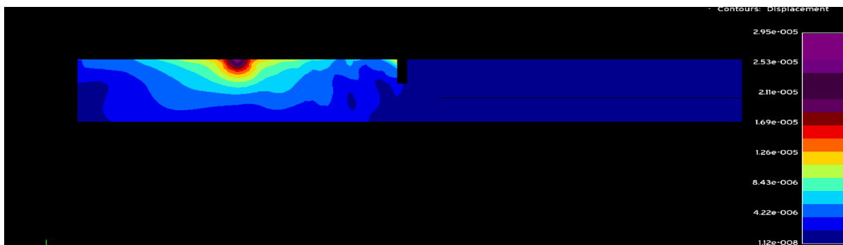
Εικόνα 4.5.9: Περίγραμμα μετατοπίσεων για συχνότητα αρμονικής δύναμης f = 75\text{Hz} με βάθος ορύγματος h = 2,5\text{m} και μήκος ορύγματος c = 0,75\text{m}
