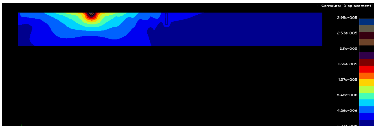
Εικόνα 4.5.17: Περίγραμμα μετατοπίσεων για συχνότητα αρμονικής δύναμης f = 75\text{Hz} με βάθος επικαλυμμένου με σκυρόδεμα ορύγματος h = 2,5\text{m} και μήκος ορύγματος c = 0,5\text{m}
