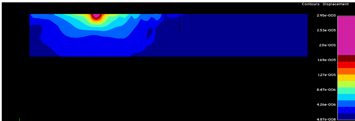
Εικόνα 4.5.19: Περίγραμμα μετατοπίσεων για συχνότητα αρμονικής δύναμης f = 75\text{Hz} με βάθος επικαλυμμένου με σκυρόδεμα ορύγματος h = 5\text{m} και μήκος ορύγματος c = 0,5\text{m}
