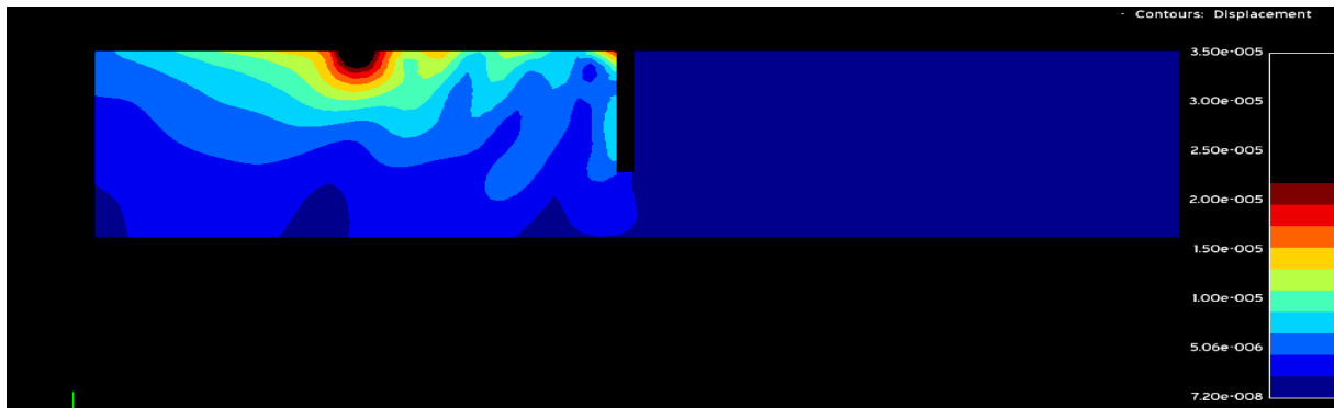
εικόνα 4.4.15: Περίγραμμα μετατοπίσεων για συχνότητα αρμονικής δύναμης f = 50\text{Hz} με βάθος ορύγματος h = 7,5\text{m} και μήκος ορύγματος c = 0,75\text{m}
