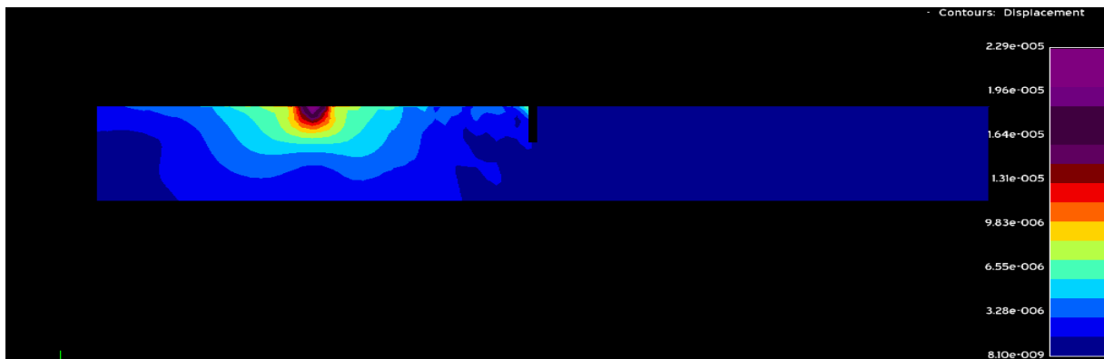
Εικόνα 4.6.11: Περίγραμμα μετατοπίσεων για συχνότητα αρμονικής δύναμης f = 100\text{Hz} με βάθος ορύγματος h = 2,5\text{m} , μήκος ορύγματος c = 0,5\text{m} και μήκος στοιχείων l = 0,7\text{m}
