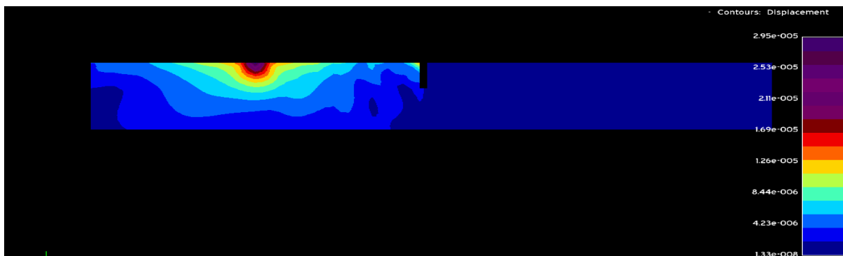
Εικόνα 4.5.3: Περίγραμμα μετατοπίσεων για συχνότητα αρμονικής δύναμης f = 75\text{Hz} με βάθος ορύγματος h = 2,5\text{m} και μήκος ορύγματος c = 0,5\text{m}
