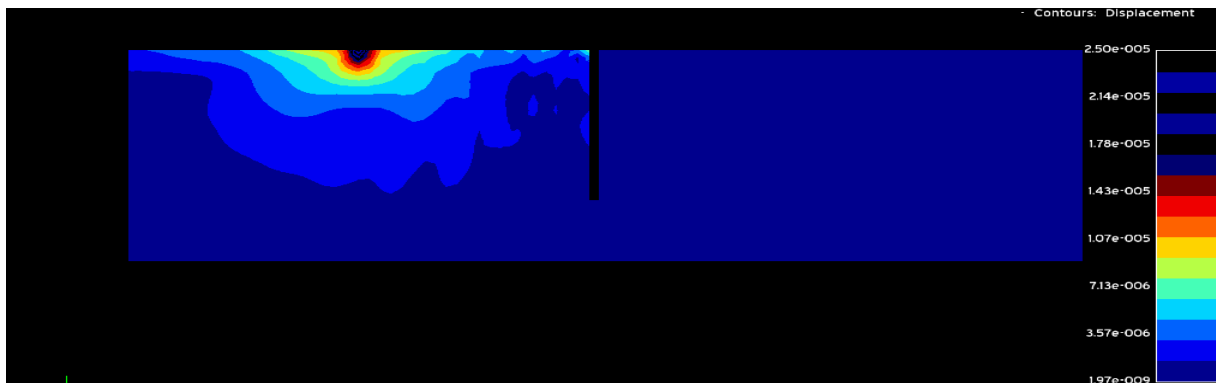
Εικόνα 4.6.9: Περίγραμμα μετατοπίσεων για συχνότητα αρμονικής δύναμης f = 100\text{Hz} με βάθος ορύγματος h = 10\text{m} , μήκος ορύγματος c = 0,5\text{m} και μήκος στοιχείων l = 0,1\text{m}
