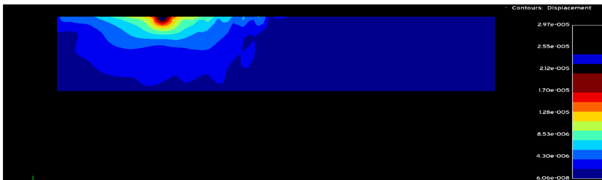
Εικόνα 4.5.21: Περίγραμμα μετατοπίσεων για συχνότητα αρμονικής δύναμης f = 75\text{Hz} με βάθος επικαλυμμένου με σκυρόδεμα ορύγματος h = 7,5\text{m} και μήκος ορύγματος c = 0,5\text{m}
