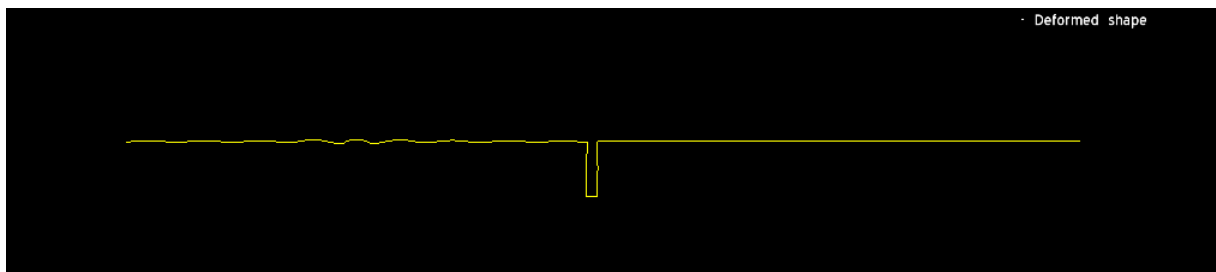
Εικόνα 4.6.4: Παραμόρφωση του εδάφους για συχνότητα αρμονικής δύναμης f = 100\text{Hz} με βάθος ορύγματος h = 2,5\text{m} , μήκος ορύγματος c = 0,5\text{m} και μήκος στοιχείων l = 0,1\text{m}
