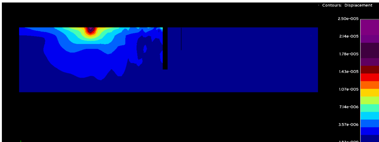
Εικόνα 4.6.33: Περίγραμμα μετατοπίσεων για συχνότητα αρμονικής δύναμης f = 100\text{Hz} με βάθος ορύγματος h = 7,5\text{m} και μήκος ορύγματος c = 0,75\text{m}
