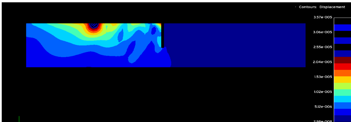
Εικόνα 4.4.5: Περίγραμμα μετατοπίσεων για συχνότητα αρμονικής δύναμης f = 50\text{Hz} με βάθος ορύγματος h = 5\text{m} και μήκος ορύγματος c = 0,5\text{m}
