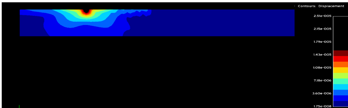
Εικόνα 4.6.37: Περίγραμμα μετατοπίσεων για συχνότητα αρμονικής δύναμης f = 100\text{Hz} με βάθος επικαλυμμένου με σκυρόδεμα ορύγματος h = 2,5\text{m} και μήκος ορύγματος c = 0,5\text{m}
