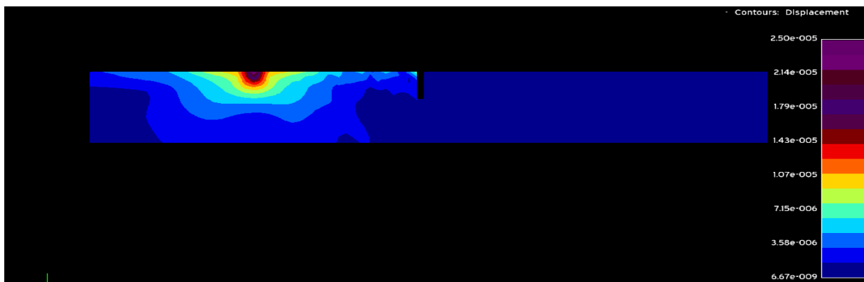
Εικόνα 4.6.3: Περίγραμμα μετατοπίσεων για συχνότητα αρμονικής δύναμης f = 100\text{Hz} με βάθος ορύγματος h = 2,5\text{m} , μήκος ορύγματος c = 0,5\text{m} και μήκος στοιχείων l = 0,1\text{m}
