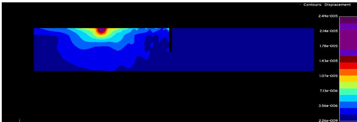
Εικόνα 4.6.5: Περίγραμμα μετατοπίσεων για συχνότητα αρμονικής δύναμης f = 100\text{Hz} με βάθος ορύγματος h = 5\text{m} , μήκος ορύγματος c = 0,5\text{m} και μήκος στοιχείων l = 0,1\text{m}
