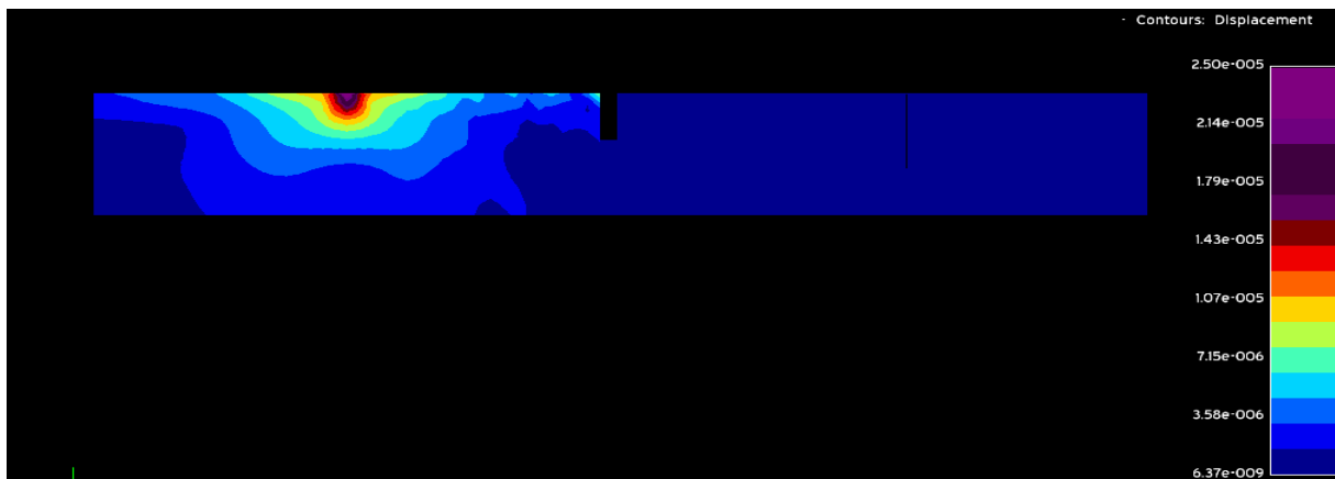
Εικόνα 4.6.29: Περίγραμμα μετατοπίσεων για συχνότητα αρμονικής δύναμης f = 100\text{Hz} με βάθος ορύγματος h = 2,5\text{m} και μήκος ορύγματος c = 0,75\text{m}
