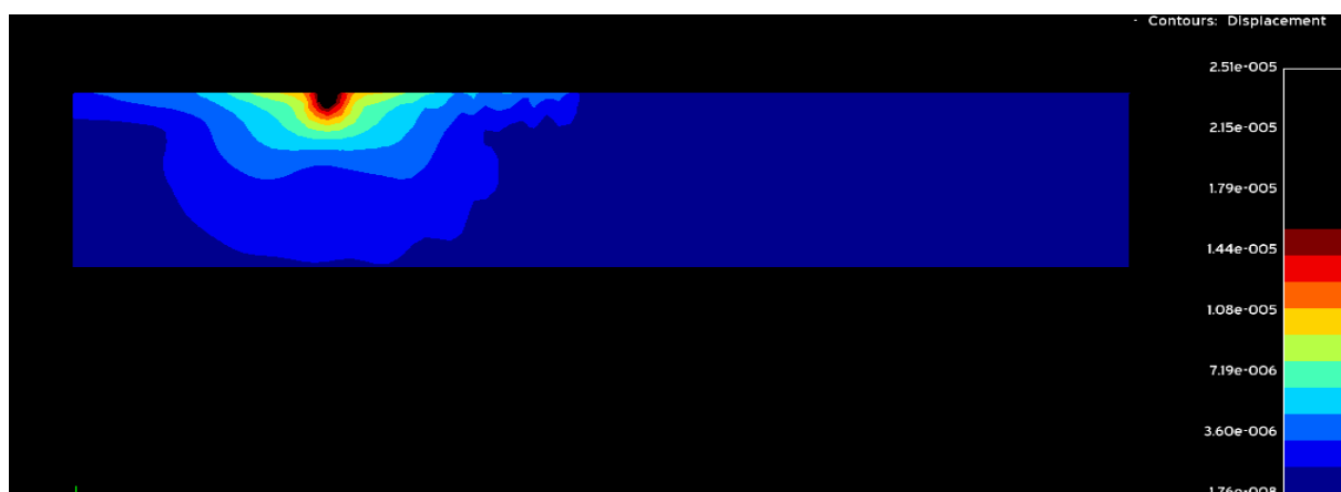
Εικόνα 4.6.39: Περίγραμμα μετατοπίσεων για συχνότητα αρμονικής δύναμης f = 100\text{Hz} με βάθος επικαλυμμένου με σκυρόδεμα ορύγματος h = 5\text{m} και μήκος ορύγματος c = 0,5\text{m}
