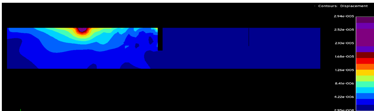
Εικόνα 4.5.11: Περίγραμμα μετατοπίσεων για συχνότητα αρμονικής δύναμης f = 75\text{Hz} με βάθος ορύγματος h = 5\text{m} και μήκος ορύγματος c = 0,75\text{m}
