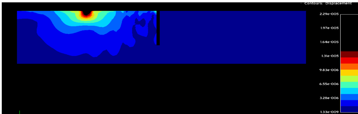
Εικόνα 4.6.20: Περίγραμμα μετατοπίσεων για συχνότητα αρμονικής δύναμης f = 100\text{Hz} με βάθος ορύγματος h = 7,5\text{m} , μήκος ορύγματος c = 0,5\text{m} και μήκος στοιχείων l = 0,7\text{m}
