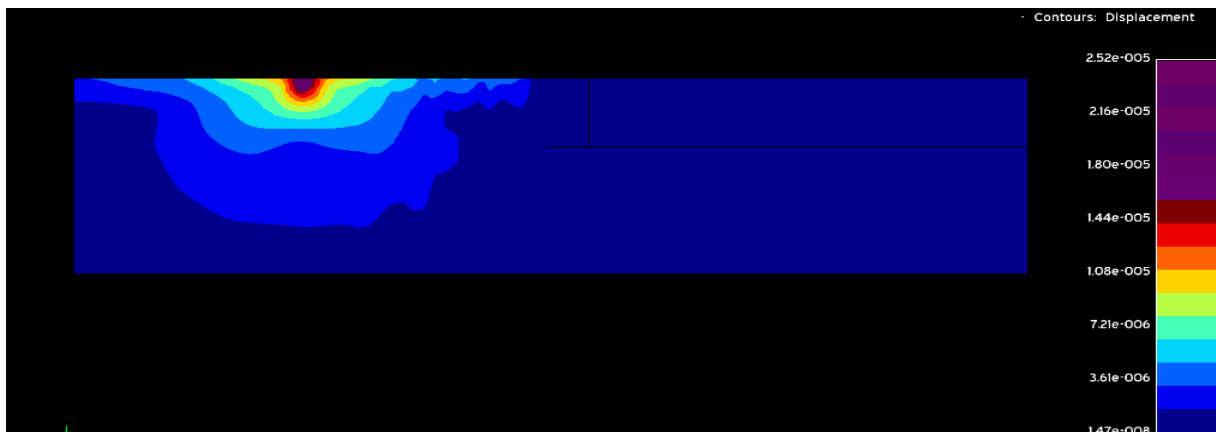
Εικόνα 4.6.41: Περίγραμμα μετατοπίσεων για συχνότητα αρμονικής δύναμης f = 100\text{Hz} με βάθος επικαλυμμένου με σκυρόδεμα ορύγματος h = 7,5\text{m} και μήκος ορύγματος c = 0,5\text{m}
