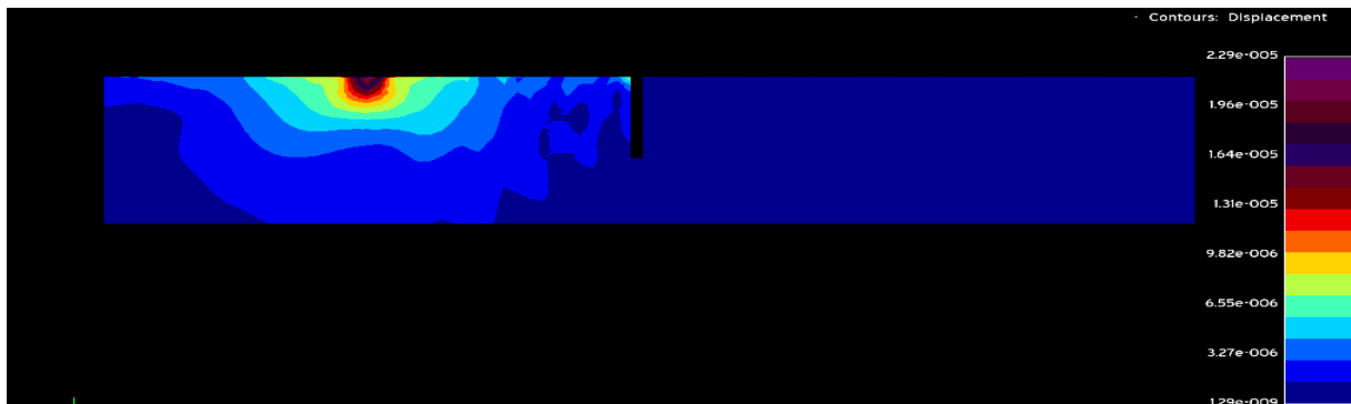
Εικόνα 4.6.13: Περίγραμμα μετατοπίσεων για συχνότητα αρμονικής δύναμης f = 100\text{Hz} με βάθος ορύγματος h = 5\text{m} , μήκος ορύγματος c = 0,5\text{m} και μήκος στοιχείων l = 0,7\text{m}
