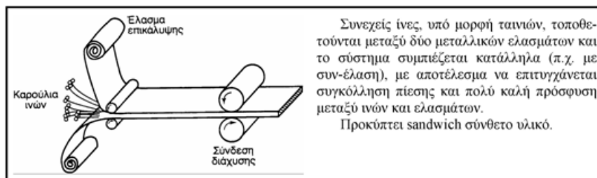
Σχήμα 1- 23 Μορφοποίηση συνθέτων μεταλλικής μήτρας με συμπίεση.
