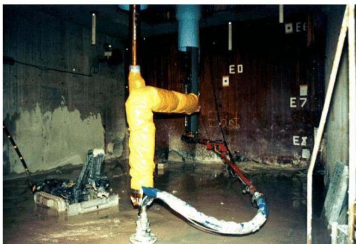
Εικόνα 2.5: Ρομποτική συσκευή για την ανάκτηση αποβλήτων (Oak Ridge National Laboratory).
