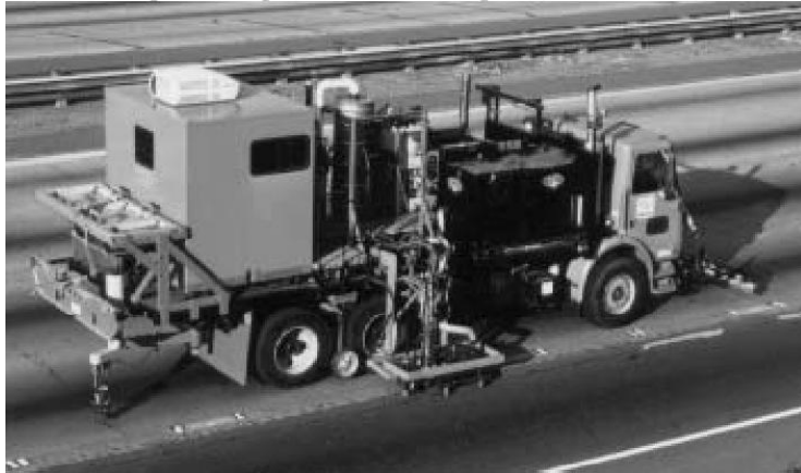
Εικόνα 2.6: Αυτόματη μηχανή σφράγισης ρωγμών, που αναπτύχθηκε από την UC Davis.
