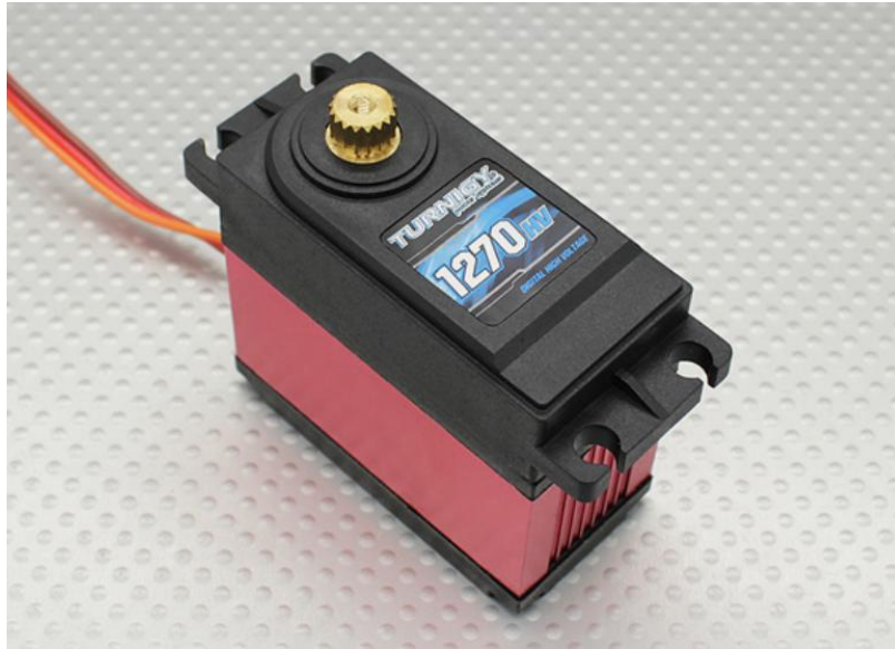
Εικόνα 4.4: Σερβοκινητήρας που χρησιμοποιήθηκε στην κατασκευή του ρομποτικού βραχίονα στο παρόν εργαστήριο.
