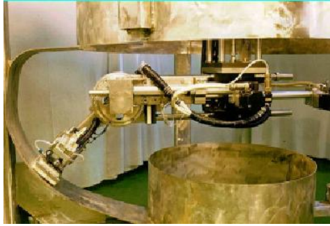
Εικόνα 2.1: Ρομπότ καθαρίζει το περίβλημα της κύριας αντλίας κυκλοφορίας ενός πυρηνικού σταθμού.
