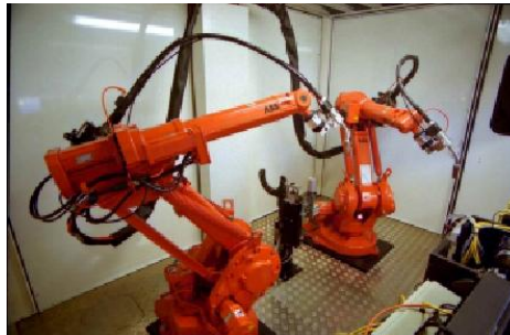
Εικόνα 2.2: Ρομπότ που επιτελεί εργασία συγκόλλησης.
