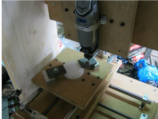
Σχήμα 74: Στήριξη του dremel στην κινούμενη βάση του Z' άξονα.
