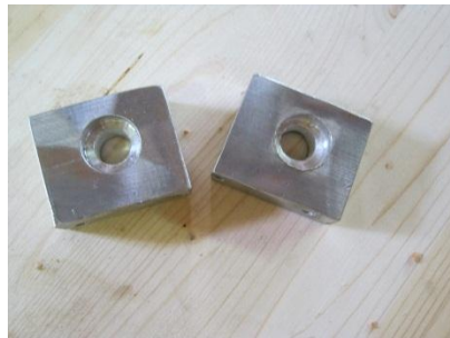
Σχήμα 36: Τα στηρίγματα με τις υποδοχές των ρουλεμάν σε φωτογραφία.
