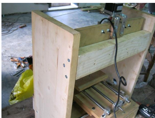
Σχήμα 72: Στήριξη της οριζόντιας δοκού στο ένα άκρο.
