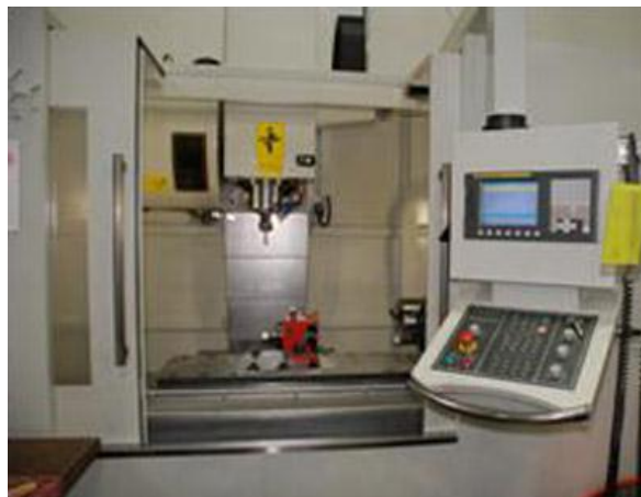
Σχήμα 6: Κέντρο κατεργασίας που εκτελεί εργασίες φρέζας και τόννου.
