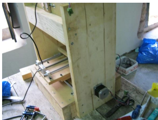
Σχήμα 73: Στήριξη της οριζόντιας δοκού στο άλλο άκρο.
