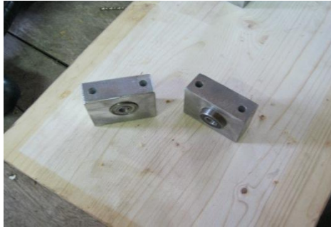
Σχήμα 37: Τα στηρίγματα την στιγμή που σφηνώνω μέσα τα ρουλεμάν.
