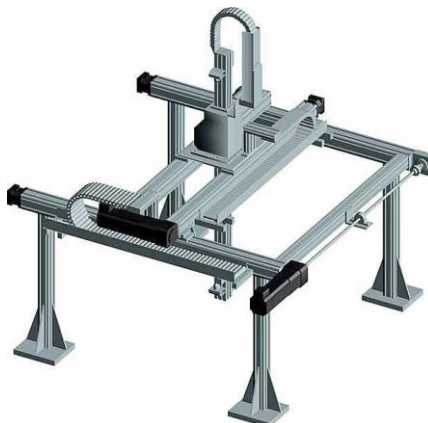
Σχήμα 9: Βιομηχανικό ρομπότ καρτεσιανών συντεταγμένων.
