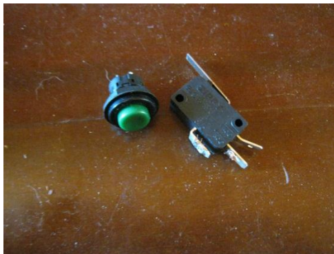
Σχήμα 54: Τερματικός διακόπτης και button που χρησιμοποιώ για emergency stop (το button είναι με το εξάρτημα με το πράσινο χρώμα στο άνω μέρος του).
