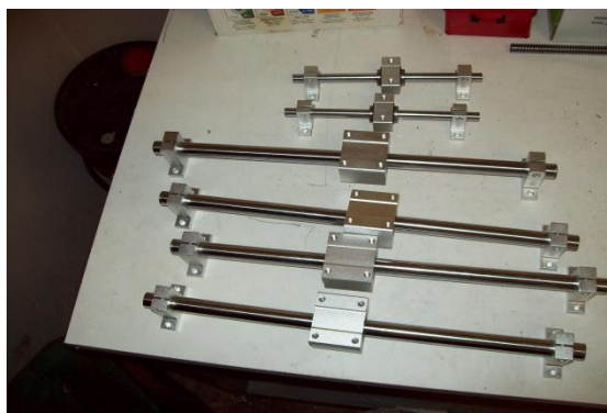
Σχήμα 30: Οι ράγες με τα στηρίγματά τους και τα γραμμικά ρουλεμάν (2 για τον X', 2 για τον Y' και οι δύο μικρές για τον Z').
