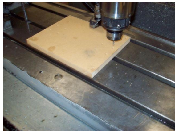
Σχήμα 56: Ανοίγω όλες τις απαιτούμενες οπές με την cnc φρέζα του εργαστηρίου.
