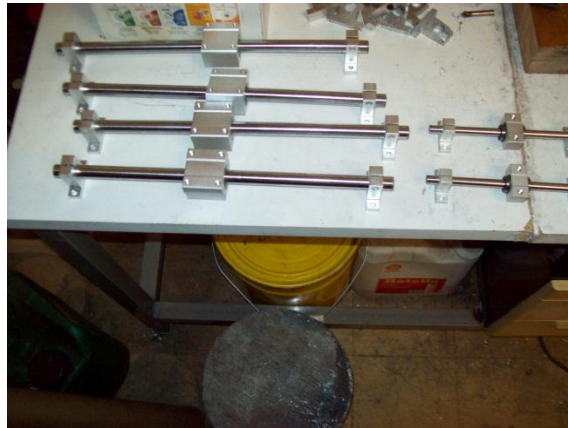
Σχήμα 55: Συναρμολόγησα τις ράγες με τα γραμμικά ρουλεμάν και τα στηρίγματα των ραγών.
