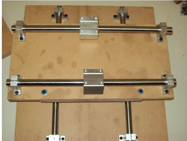
Σχήμα 60: Συναρμολόγηση της κάτω βάσης του Υ' άξονα με την ενδιάμεση βάση (έχω βγάλει εκείνη την στιγμή την τράπεζα και την ξαναβάζω λίγο αργότερα).
