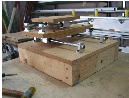
Σχήμα 65: Ολοκλήρωση την σύνδεση του πλαισίου με την κάτω βάση.
