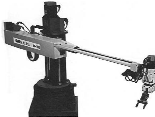
Σχήμα 10: Κυλινδρικό βιομηχανικό ρομπότ.
