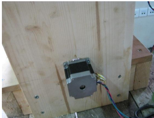
Σχήμα 70: Στερέωση κινητήρα στον X' άξονα.
