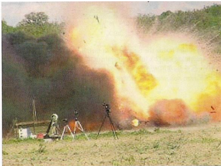
Εικόνα 4.7: Μπάλα φωτιάς υδρογόνου με ταχύτητα 170m/s μετά από θραύση δεξαμενής αποθήκευσης.
