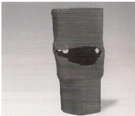
Εικόνα 2.26: Παράδειγμα κατεστραμμένου άκρου πιλότου.
