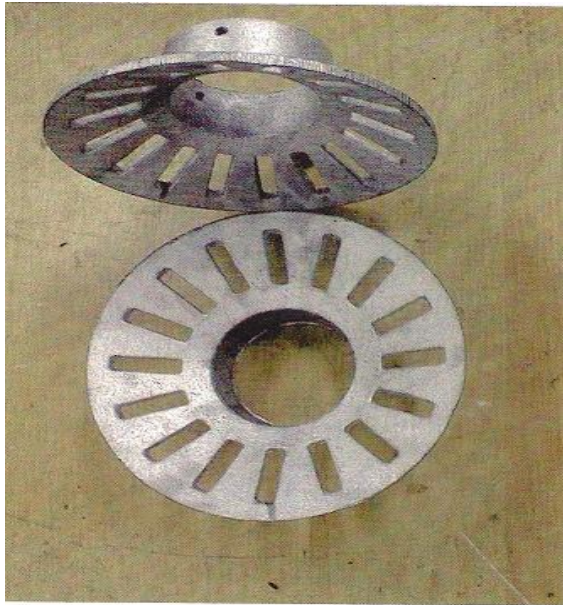
Εικόνα 2.23: Τυπικοί κώνοι διαχύτη
