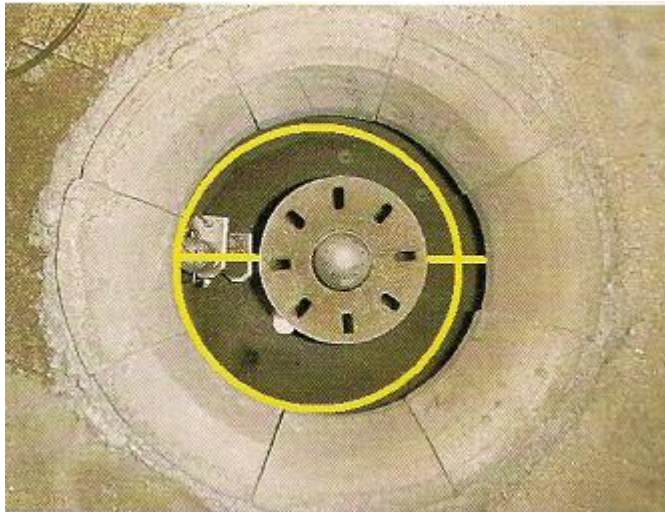
Εικόνα 2.16: Άκρο αερίου καυστήρα σε διαχύτη με πιλότο
