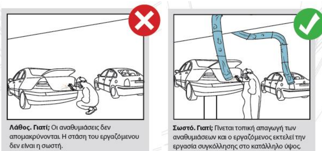
Σχ. 25 παράδειγμα 3 - έκθεση σε αναθυμιάσεις από συγκολλητικές εργασίες
