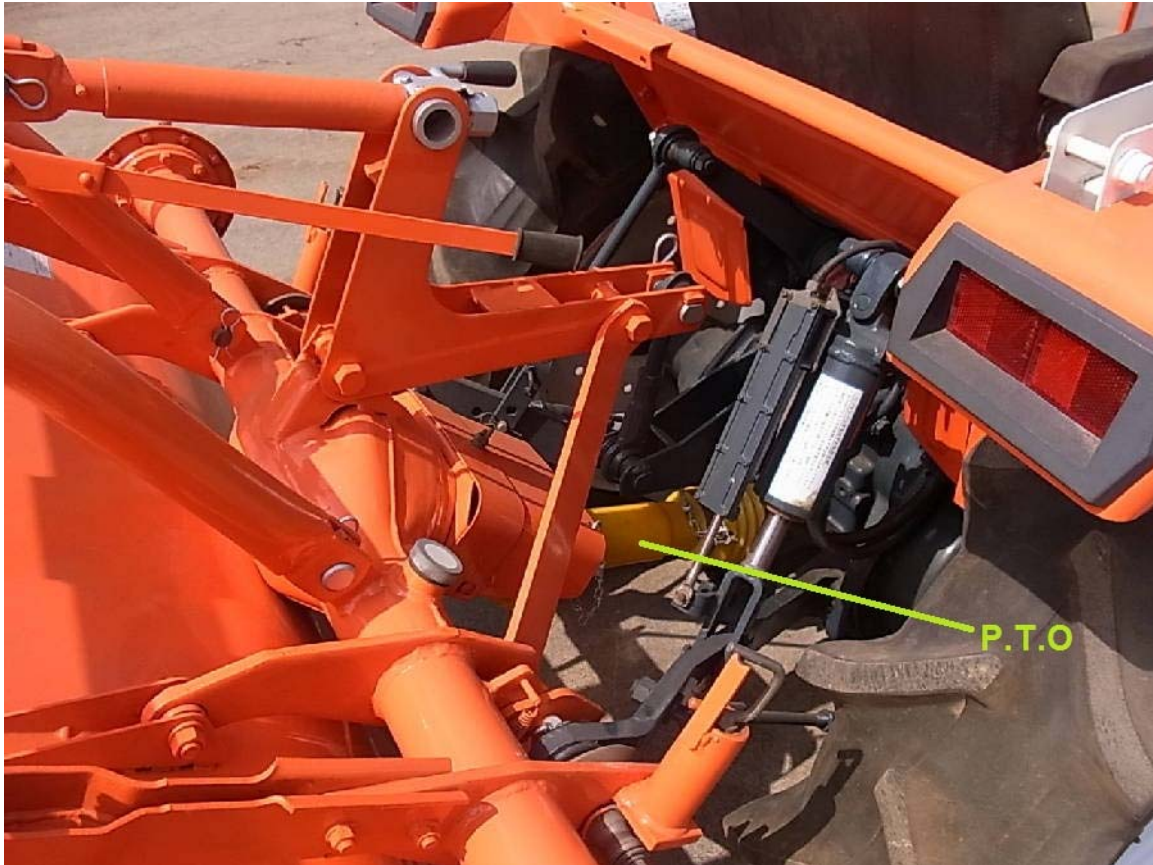
Εικόνα 1.5 Η φρέζα παίρνει κίνηση από το P.T.O. [12].
