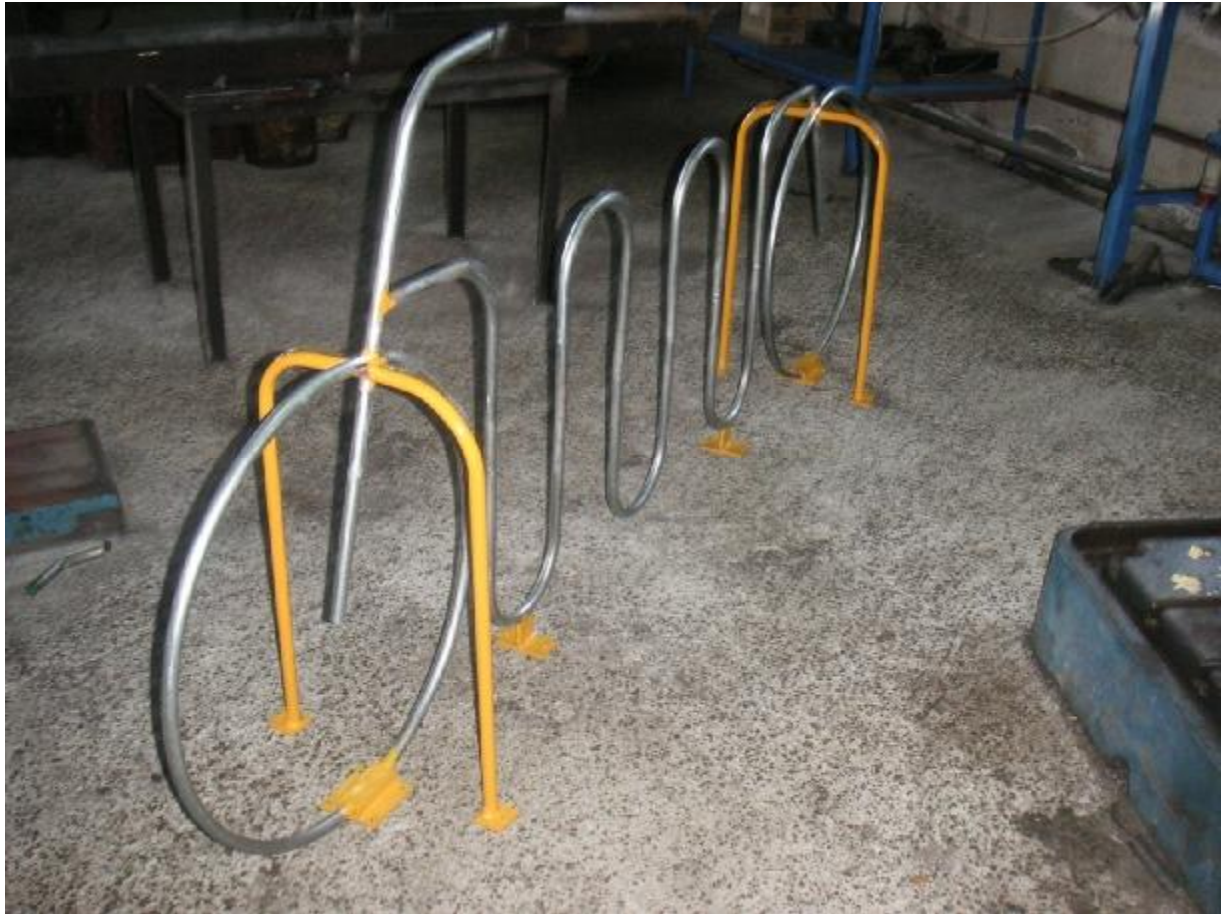
Εικόνα 22. Βάψιμο πλάγιων στηρίξεων
