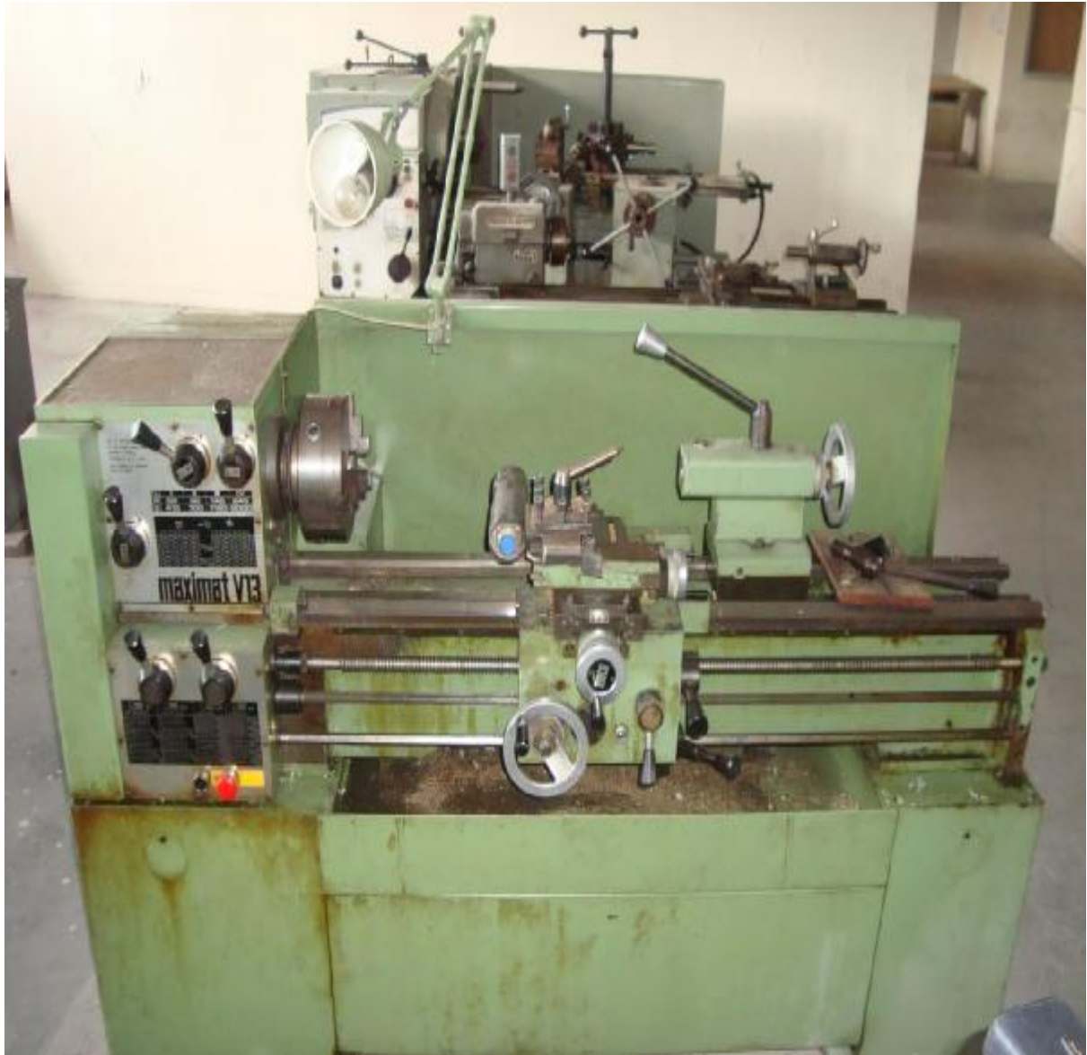
Εικόνα 8: Ο τόρνος πάνω στον οποίο προσαρμόσαμε την πειραματική συσκευή
