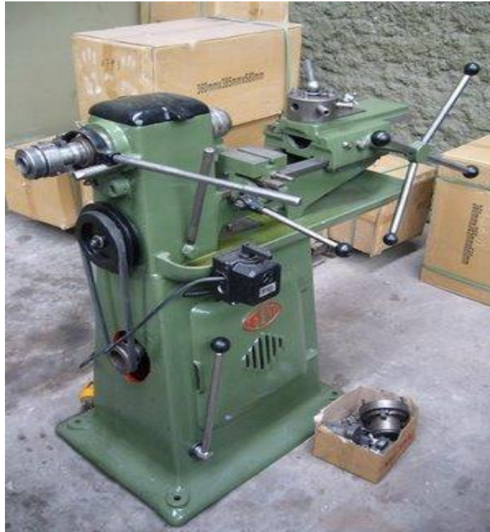
Σχήμα 2.9: Τόρνος με κατακόρυφο τον άξονα της περιστρεφόμενης κεφαλής
