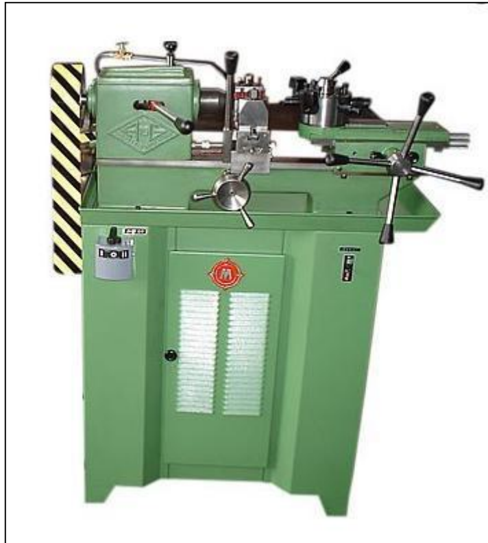
Σχήμα 2.10: Τόρνος με οριζόντιο τον άξονα της περιστρεφόμενης κεφαλής
