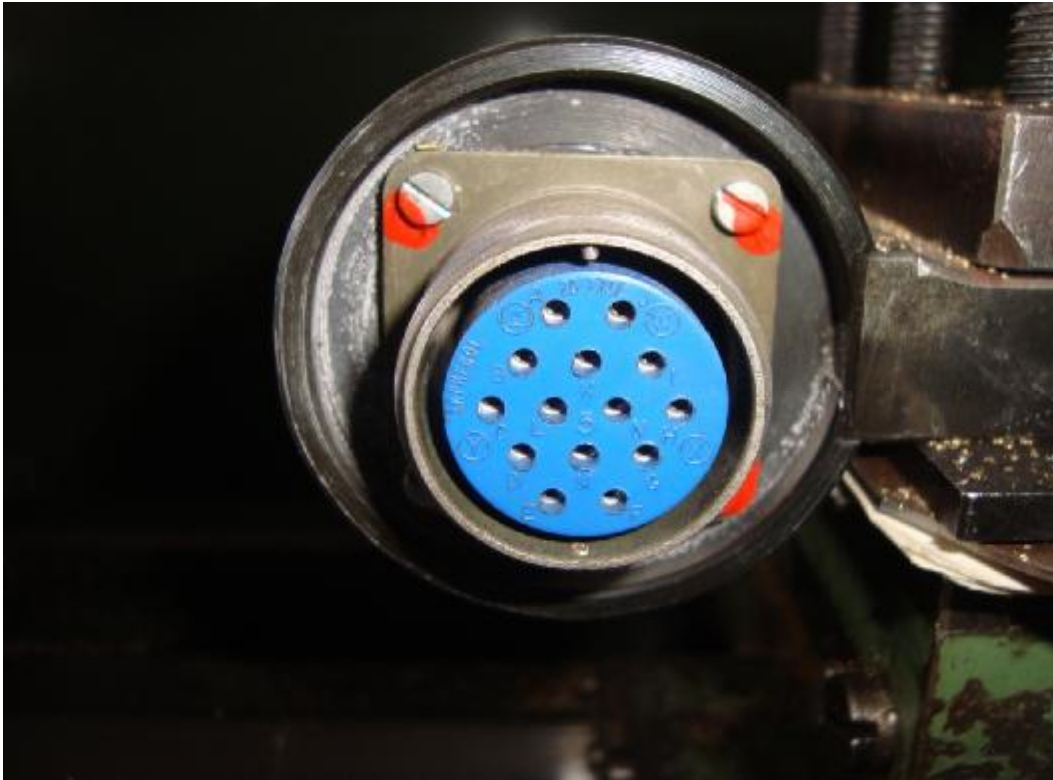
Εικόνα 7: Αισθητήρας-υποδοχή καλωδίου σύνδεσης του κοπτικού με τον μετασχηματιστή
