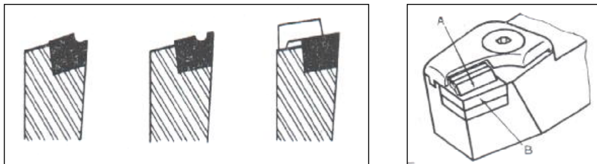
A γρεζοθραύστης, B πλακίδιο από σκληρομέταλλο.
