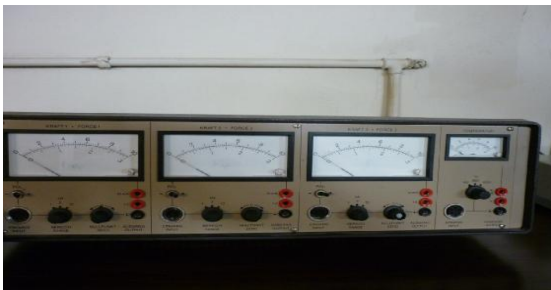
Εικόνα 2: Διακρίνονται τα τρία όμοια όργανα για την ένδειξη κάθε δυνάμεως κοπής καθώς επίσης και ένα επιπλέον για την ένδειξη της θερμοκρασίας.
