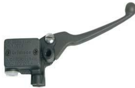
Σχήμα 1.2 Αντλία φρένου αυτοκινήτου. Σχήμα 1.3 Αντλία φρένου μοτοσυκλέτας με την μανέτα πίεσης.
