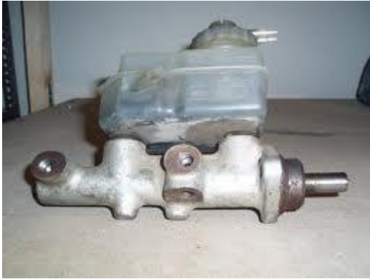
Σχήμα 1.2 Αντλία φρένου αυτοκινήτου. Σχήμα 1.3 Αντλία φρένου μοτοσυκλέτας με την μανέτα πίεσης.
