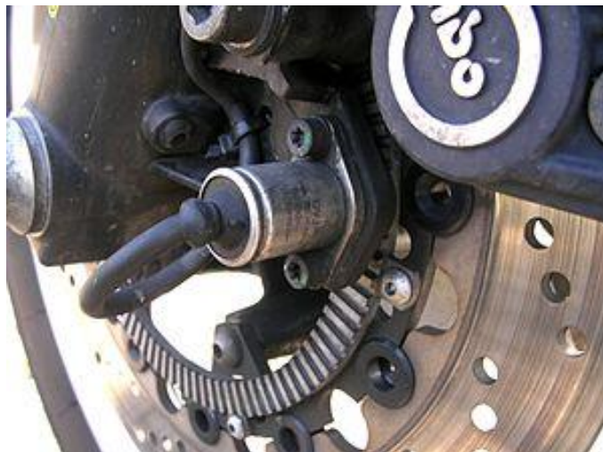
Σχήμα 2.1 Σύστημα ABS σε μοτοσυκλέτα BMW μοντέλο K του 1994.
