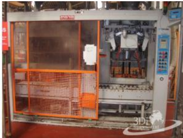
Εικόνα 8 (Αυτόματο σύστημα ενσάκκισης)
