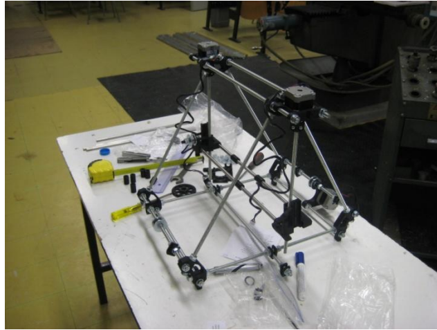
Σχήμα 24: Τοποθετημένη Πλατφόρμα Χ
