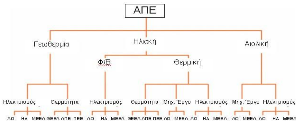
Σχήμα 4.1.: Συνδυασμός Αφαλάτωσης και ΑΠΕ
