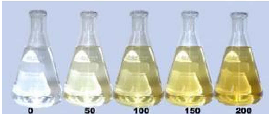
Εικόνα 2.4.: Κλίμακα Pt/Co για τον προσδιορισμό του χρώματος.
