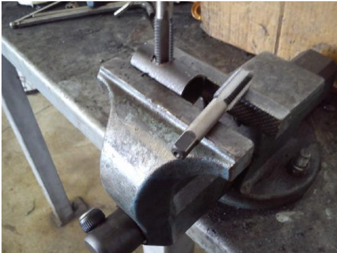
Εικόνα 32: Δημιουργία σπειρώματος στον σωλήνα
