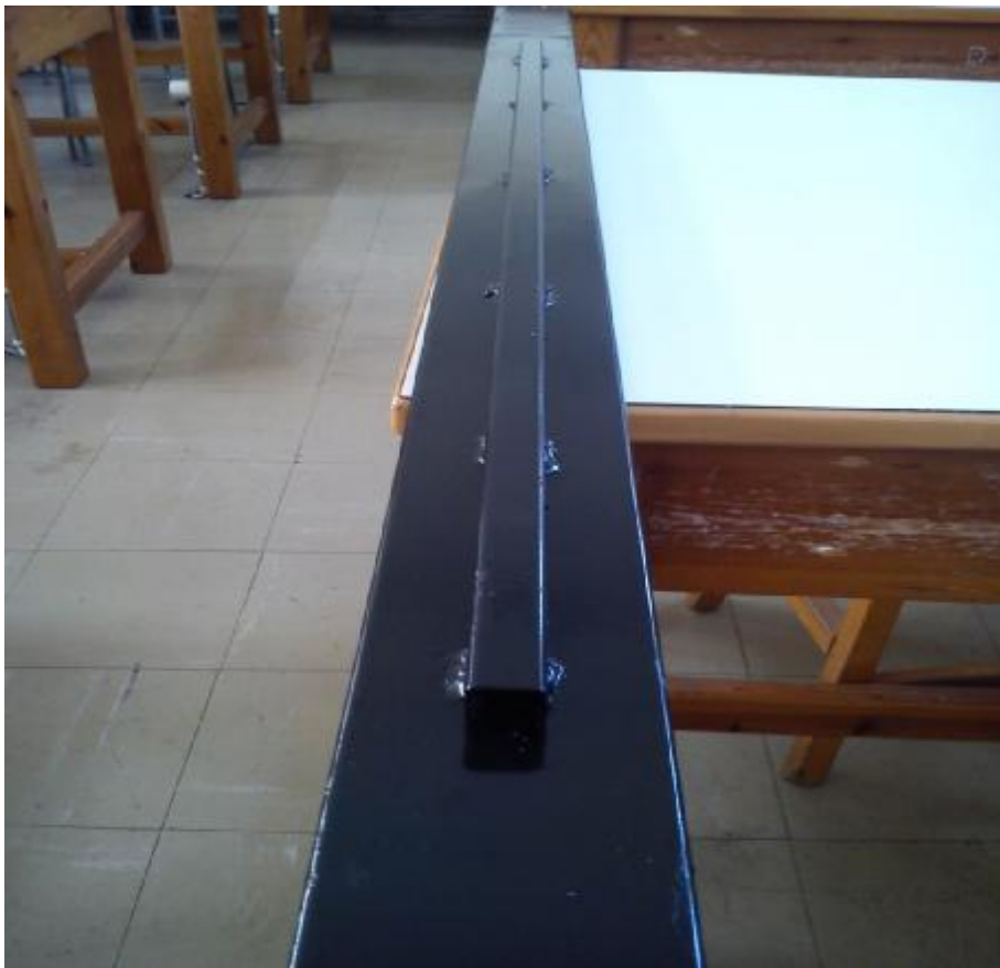
Εικόνα 22: Συγκόλληση νεύρου στο κάτω μέρος του διαδρόμου
