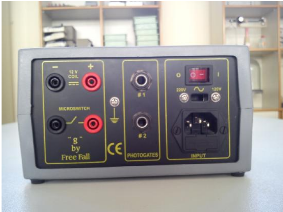
Εικόνα 39: Υποδοχές σύνδεσης των φωτοπυλών(#1, #2)
