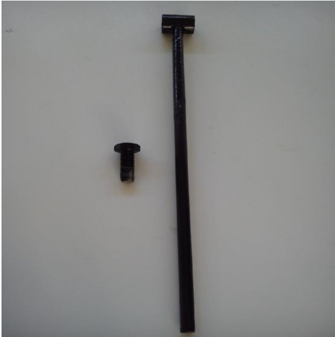
Εικόνα 33: Συγκόλληση σωλήνα και μεταλλικής βέργας
