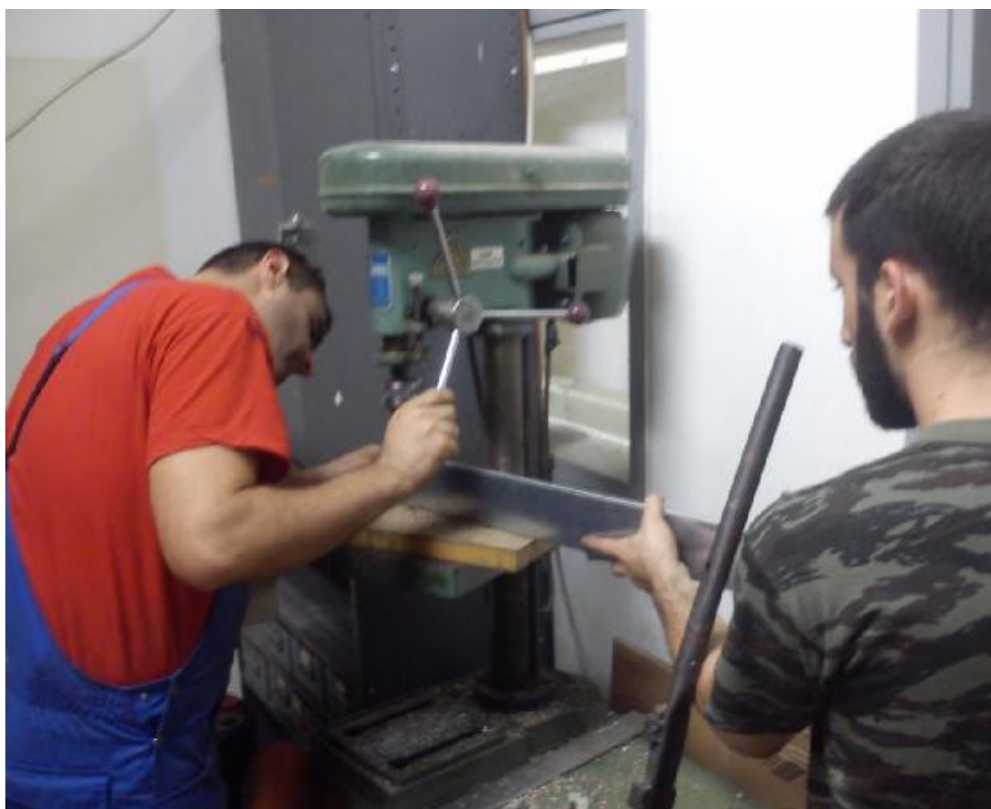
Εικόνα 13: Διάτρηση πλαϊνών διαδρόμου
