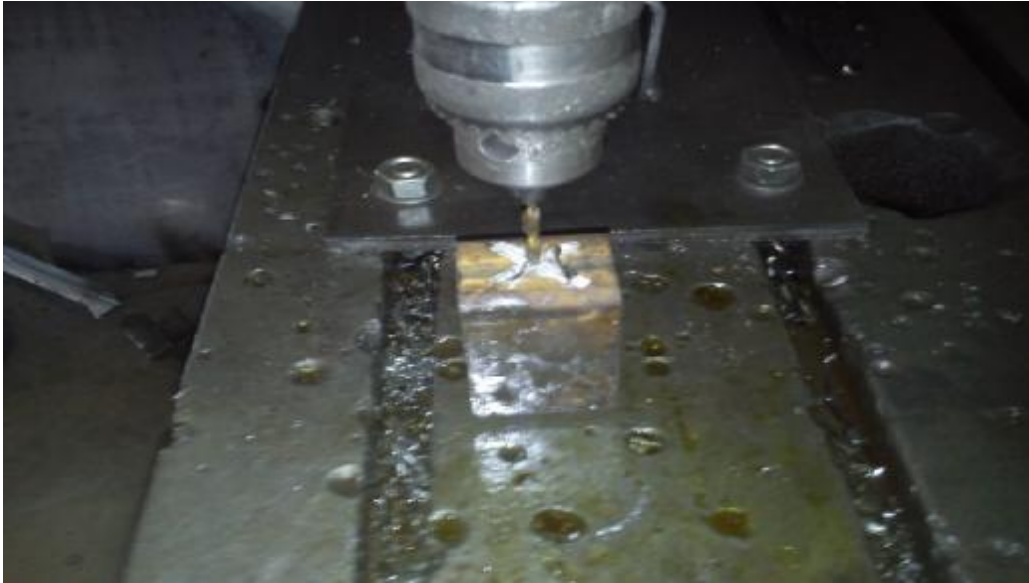
Εικόνα 14: Διάτρηση πλαϊνών κοιλοδοκού
