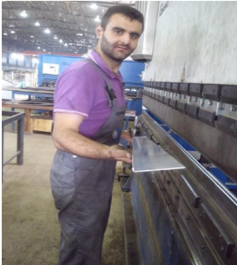
Εικόνα 3: Διαδικασία στραντζαρίσματος λαμαρίνας διαδρόμου
