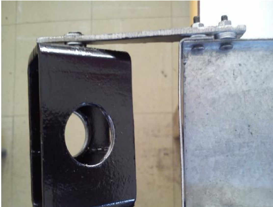
Εικόνα 17: Δοκιμή σύνδεσης πελμάτων-διαδρόμου-κοιλοδοκού
