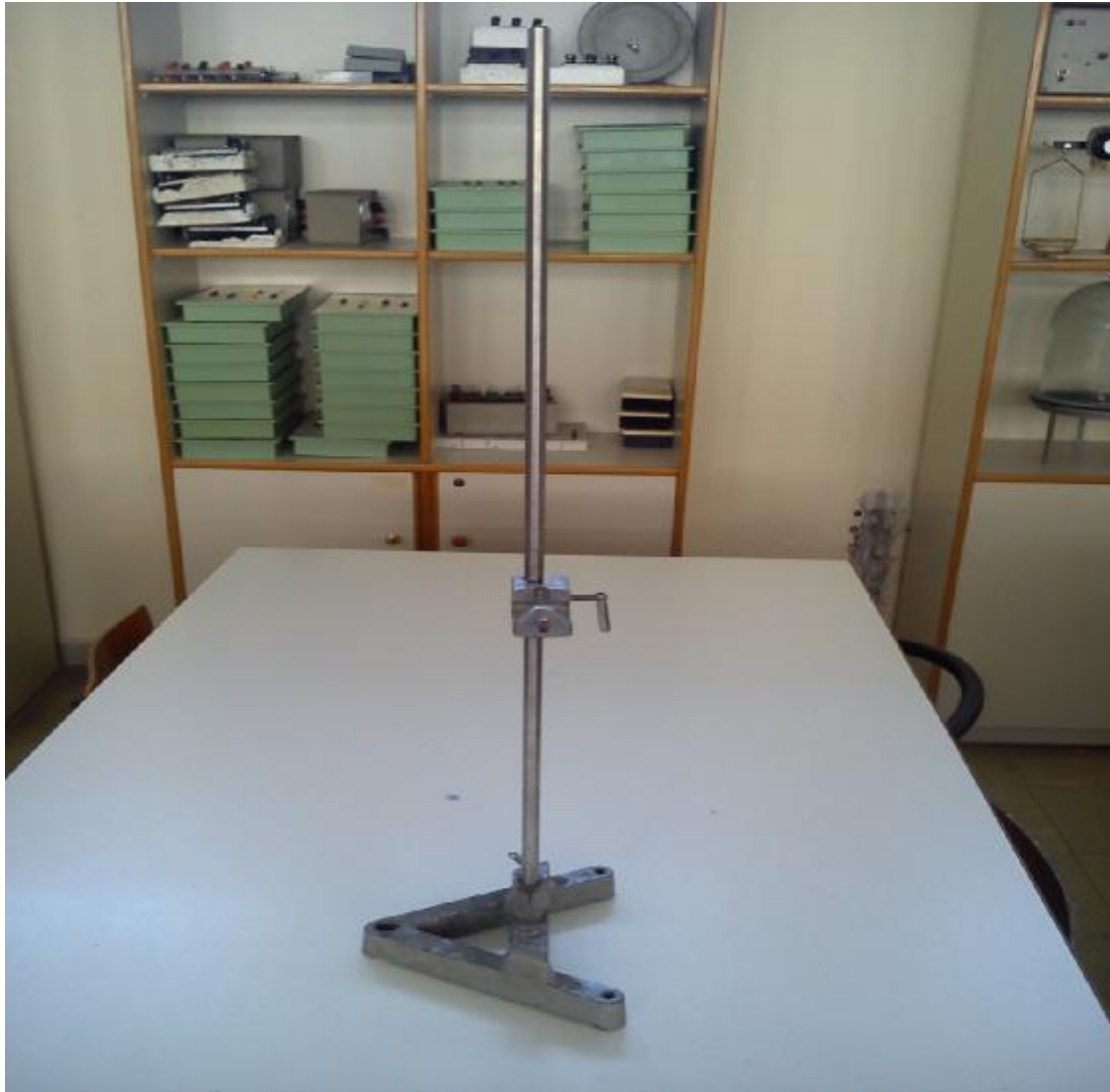
Εικόνα 29: Βάση στήριξης φωτοπυλών
