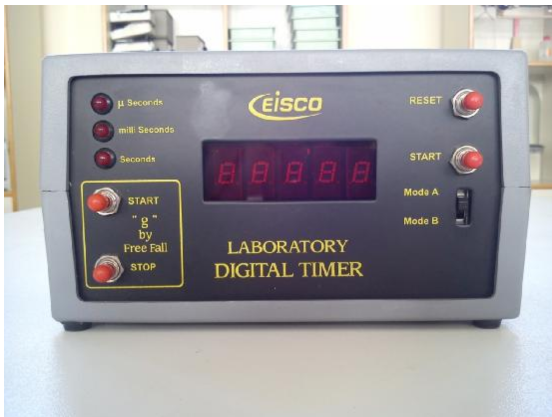
Εικόνα 38: Συσκευή μέτρησης και καταγραφής των αποτελεσμάτων του χρόνου
