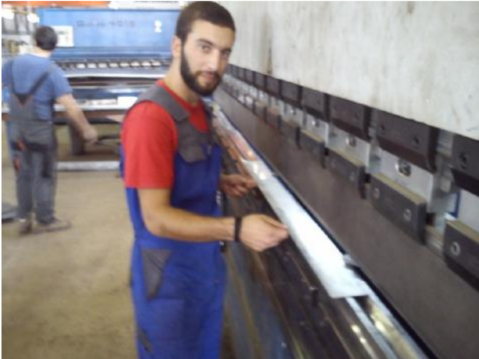
Εικόνα 21: Διαδικασία στραντζαρίσματος λαμαρίνας νεύρου
