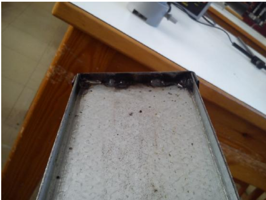
Εικόνα 36: Ασφάλειες τερματισμού άνω και κάτω άκρου του διαδρόμου
