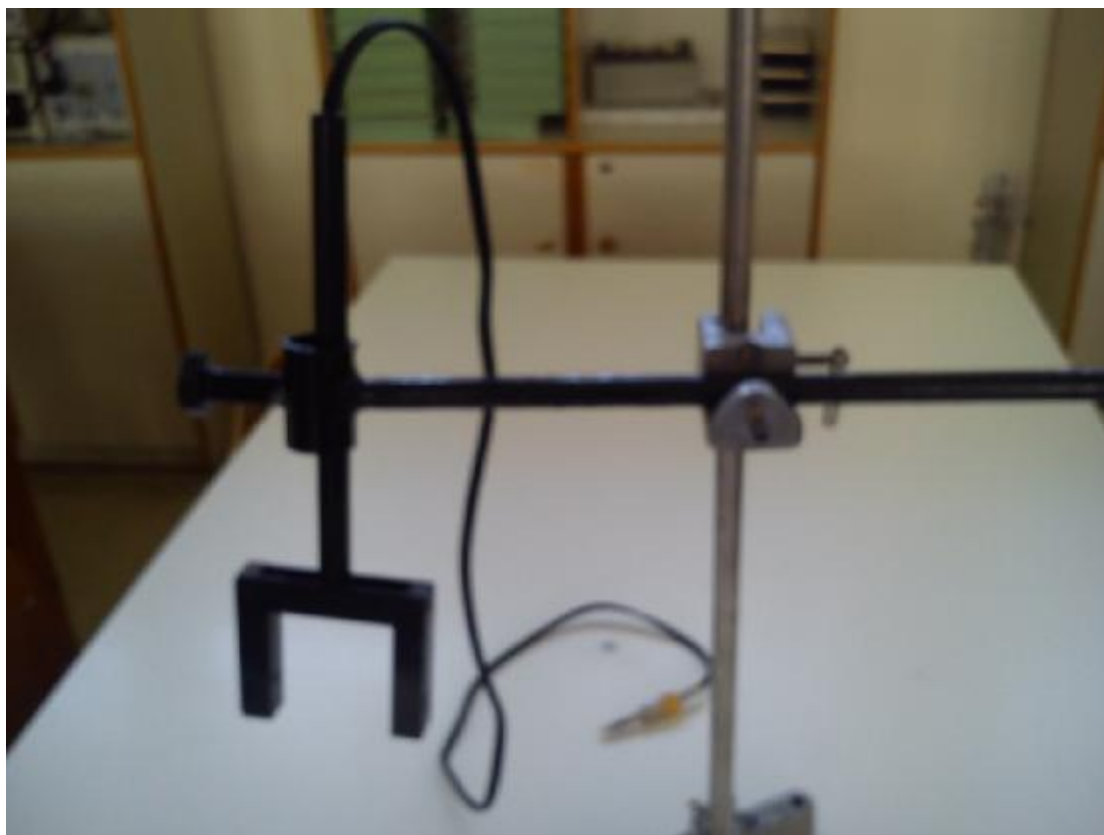
Εικόνα 35: Τελική τοποθέτηση φωτοπύλης στην βάση στήριξης
