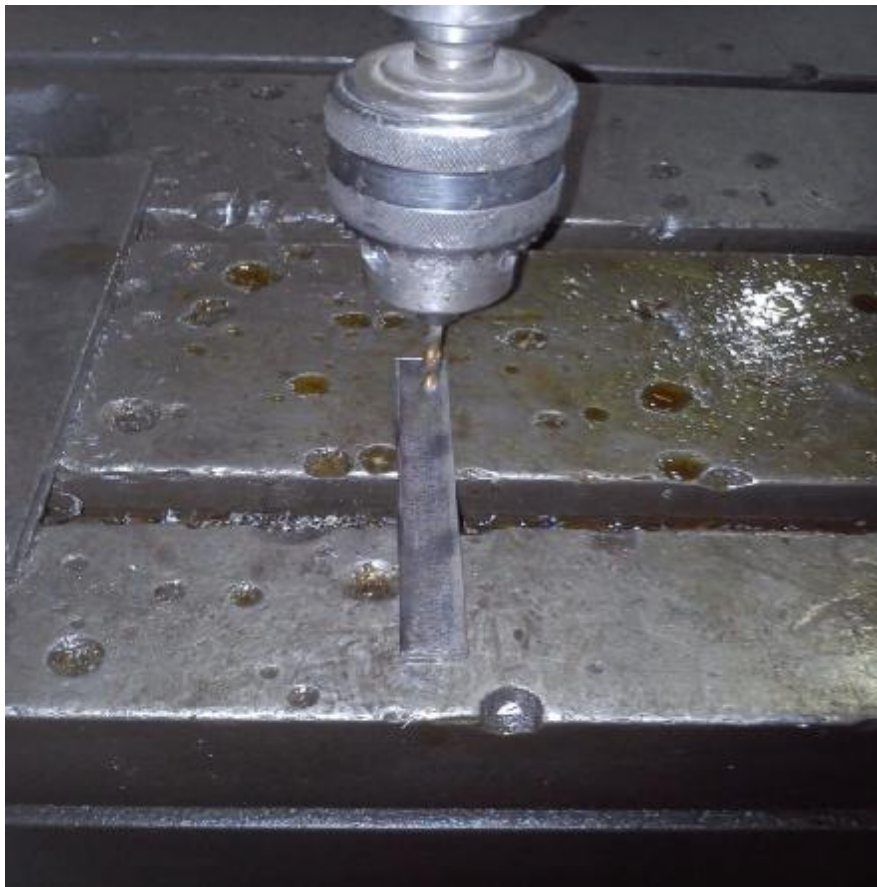
Εικόνα 15: Διάτρηση πελμάτων σύνδεσης
