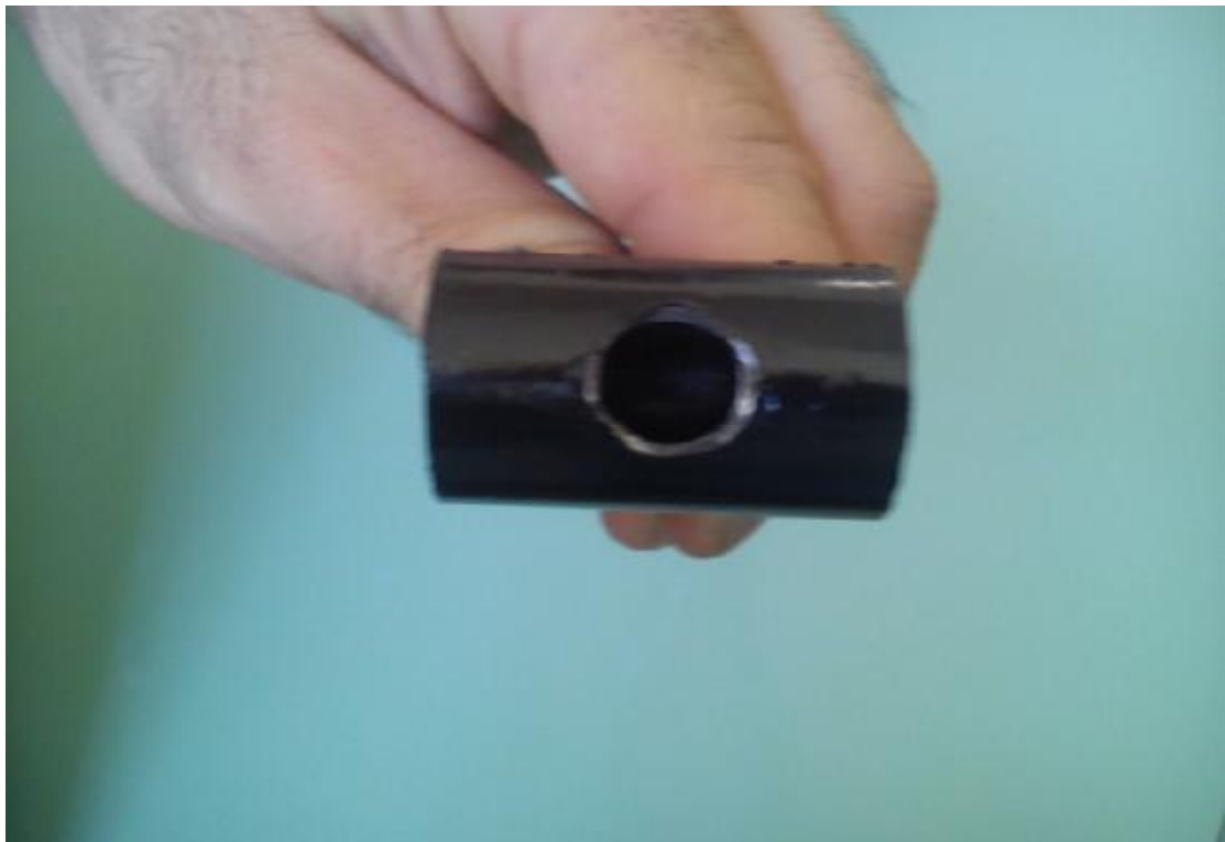
Εικόνα 31: Διάτρηση σωλήνα προέκτασης για την στήριξη των φωτοπυλών
