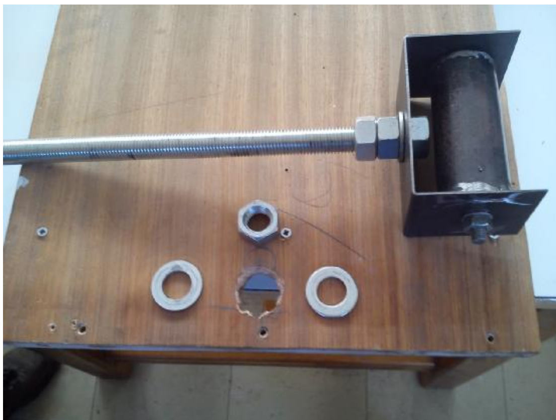
Εικόνα 9: Τελειοποιημένο ράουλο και ροδέλες-περικόχλια συνδέσεων
