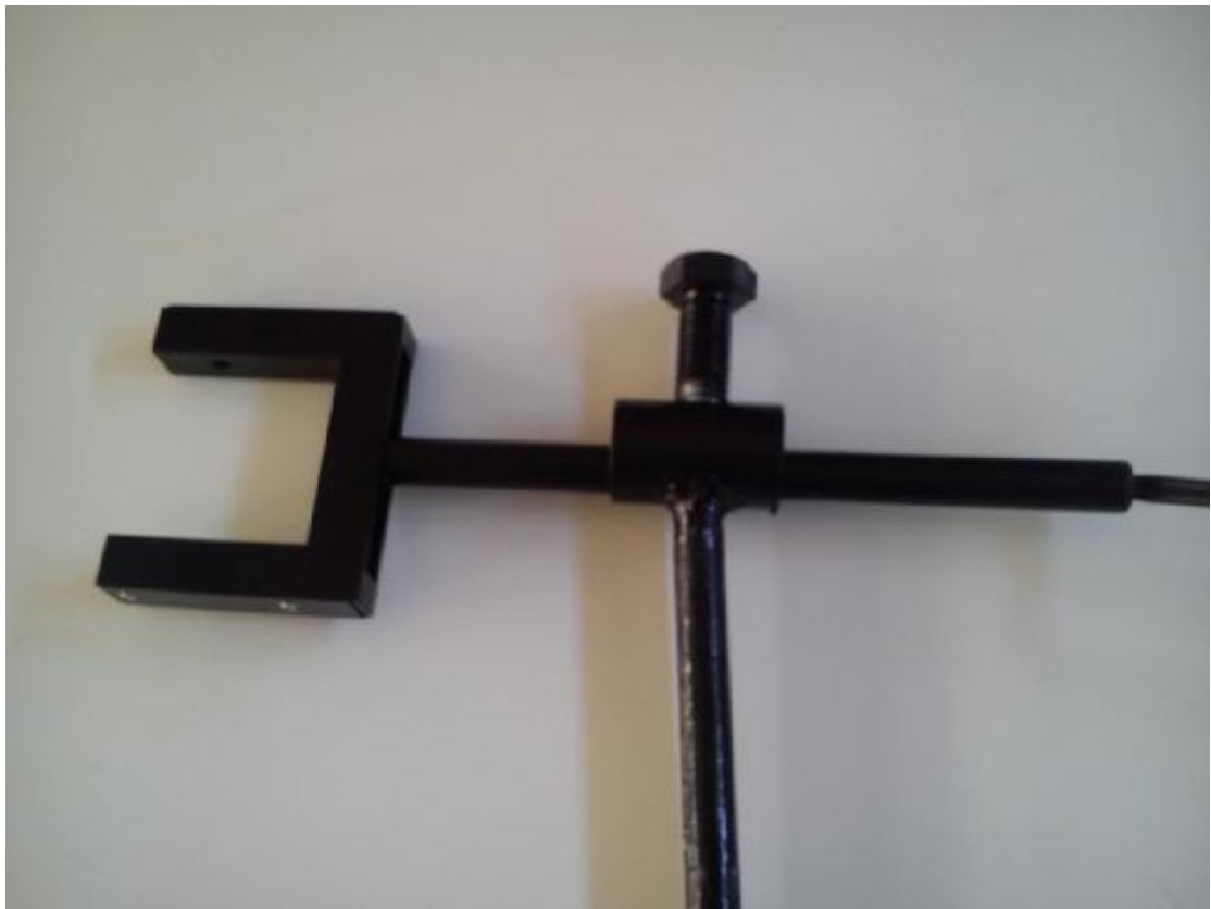
Εικόνα 34: Έλεγχος σωστής λειτουργίας της προέκτασης για την στήριξη των φωτοπυλών
