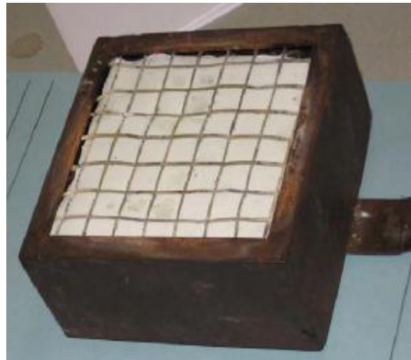
Εικόνα 3.7.β : Μεταλλικός υποδοχέας δοκιμίου, με πλέγμα στην επιφάνεια του δοκιμίου
