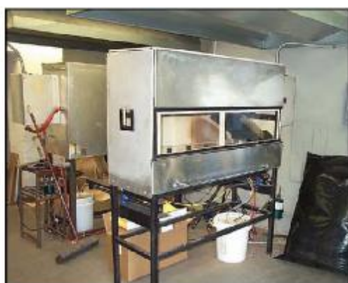
Εικόνα 4.1a: Πειραματική διάταξη Radiant Heat Panel
