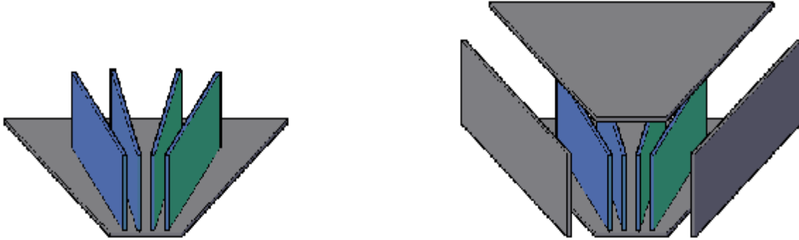
Σχήμα 3.21 : Τοποθέτηση οδηγών πτερυγίων
