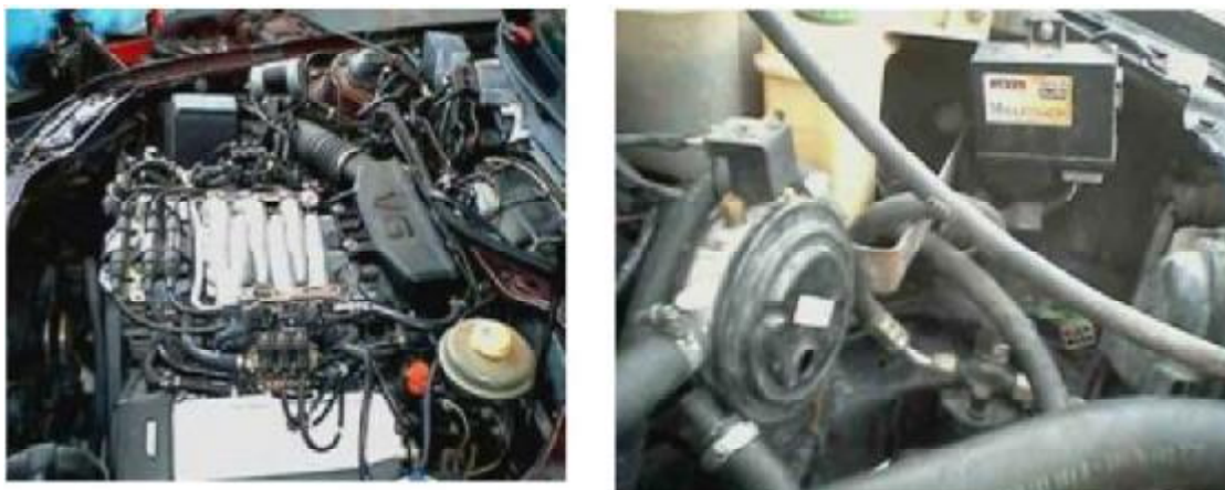
Σχήμα 28: Κινητήρας Audi 100 quattro v6 AUTOMATIC με μετατροπή για υγραέριο ( http://oxhmata.tripod.com/sitebuildercontent/sitebuilderfiles/ptyxiaki.pdf )
