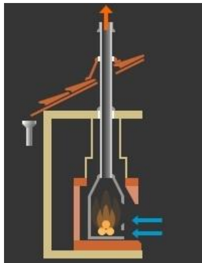
Εικ.1.10: Θάλαμος καύσης και απαγωγή καυσαερίων.
