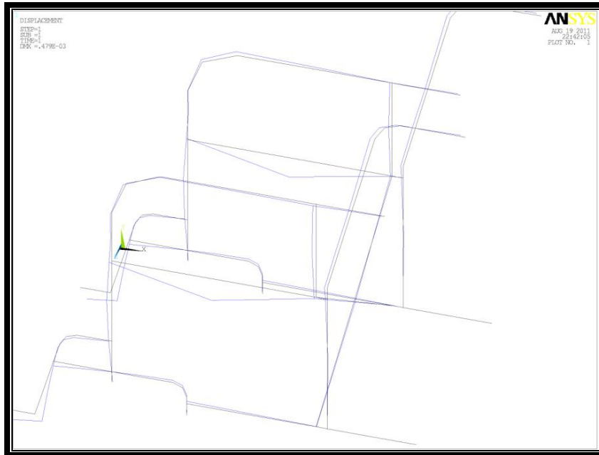
Σχήμα 5.4. Σκελετός πριν και μετά την εφαρμογή φορτίων.
