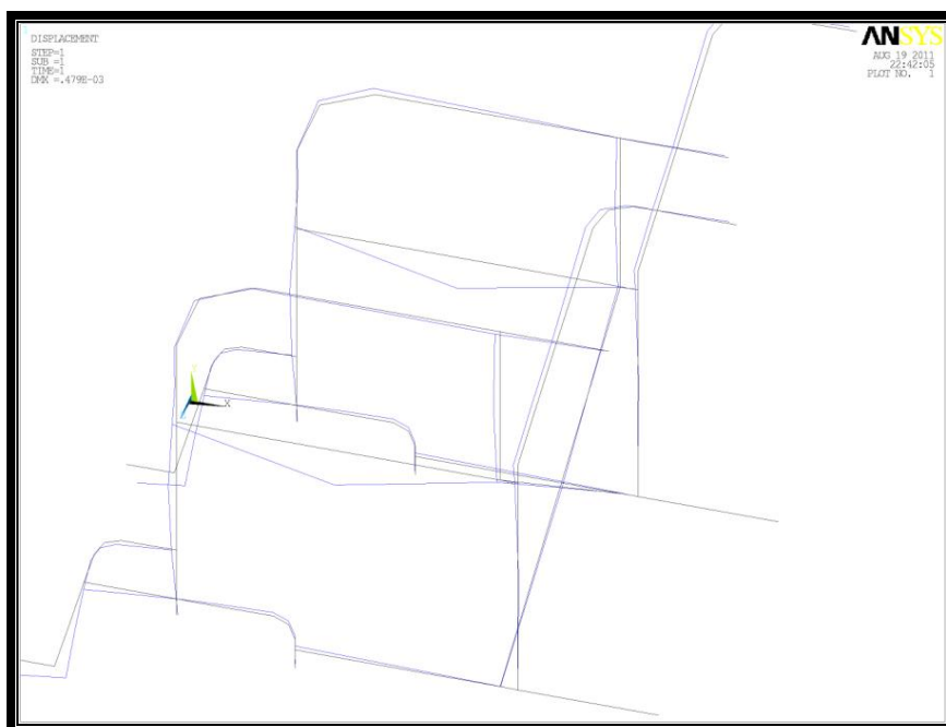
Σχήμα 5.60. Σκελετός πριν και μετά την εφαρμογή φορτίων.
