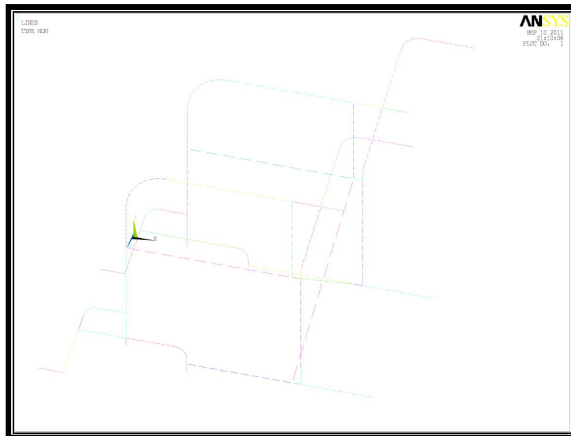
Σχήμα 5.17. Διακριτοποίηση σε 10 στοιχεία.
