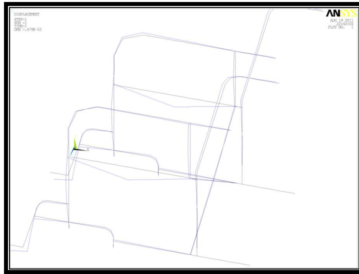
Σχήμα 5.15. Σκελετός πριν και μετά την εφαρμογή φορτίων.
