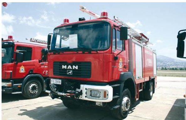
Εικόνα 1.16 : Υδροφόρο όχημα τύπου MAN 19364 F.A (4X4).
