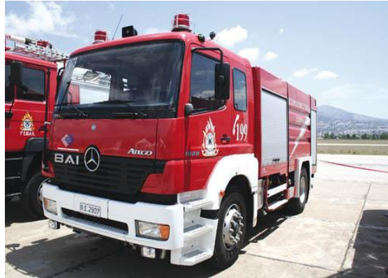
Εικόνα 1.15 : Υδροφόρο όχημα τύπου MERCEDES BENZ ATEGO 1523 (4X2).
