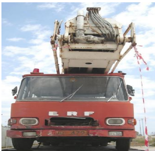
Εικόνα 1.8 : Βραχιονοφόρο όχημα ERF 84 RS , προμήθειας 1972 , αναπτύξεως 25 μέτρων.
