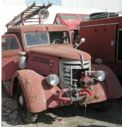
Εικόνα 1.4 : Υδροφόρο όχημα Federal , προμήθειας 1940 με δεξαμενή νερού 2500 λίτρων.
