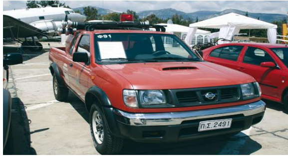
Εικόνα 1.12 : Υδροφόρο όχημα τύπου NISSAN PICAP με δεξαμενή νερού 500 λίτρων , έτος κατασκευής 2001.
