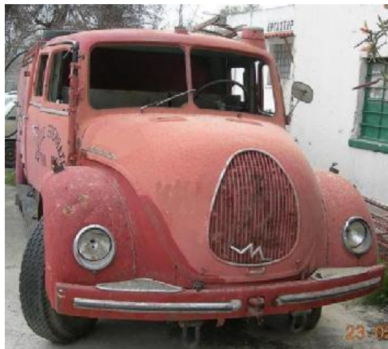
Εικόνα 1.6 : Υδροφόρο όχημα MAGIRUS DEUTZ MERCUR 125 A, προμήθειας 1957 με δεξαμενή νερού 2500 λίτρων.
