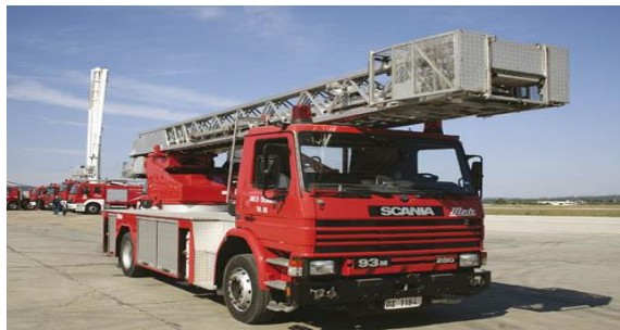
Εικόνα 1.22 : Κλιμακοφόρο όχημα τύπου SCANIA P93 ML 4X2.
