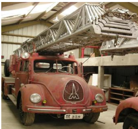
Εικόνα 1.7 : Κλιμακοφόρο όχημα MAGIRUS DEUTZ JUPITER FBL 614 , προμήθειας 1960 , αναπτύξεως 50 μέτρων.
