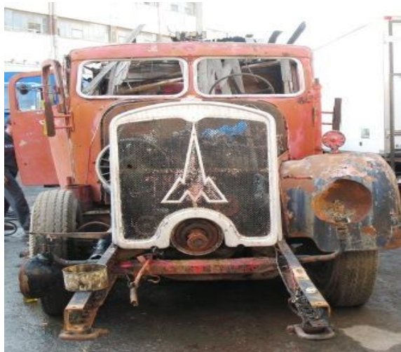
Εικόνα 1.5 : Υδροφόρο όχημα MAGIRUS DEUTZ , προμήθειας 1940 , με δεξαμενή νερού 2500 λίτρων.
