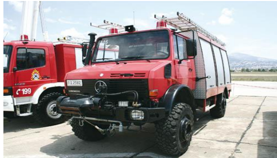
Εικόνα 1.14 : Υδροφόρο όχημα τύπου MERCEDES BENZ UNIMOG 2150L (4X4).
