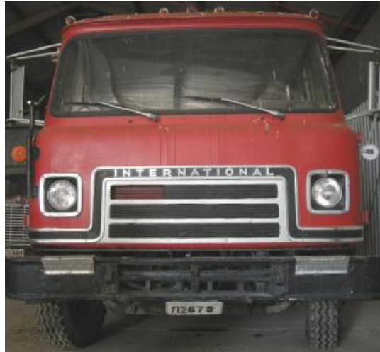
Εικόνα 1.9 : Υδροφόρο όχημα INTERNATIONAL CARGOSTAR 1700 B , προμήθειας 1978 με δεξαμενή νερού 2500 λίτρων.
