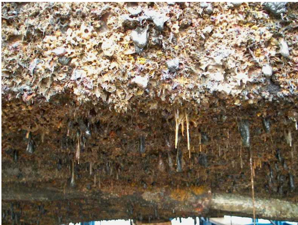
Εικόνα 10.7 Εξαιρετικά ρυπασμένη γάστρα σκάφους
