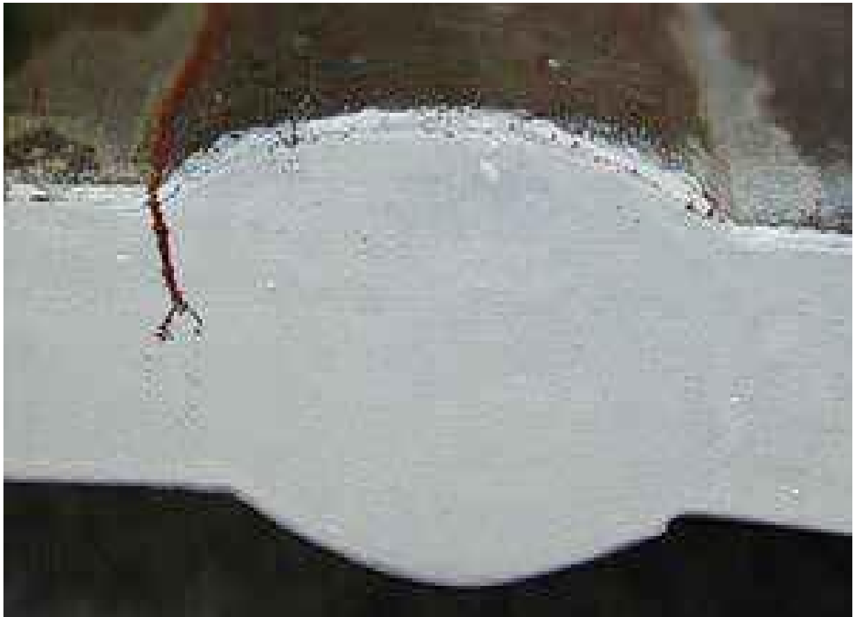
Εικόνα 3.8 Διάβρωση με μηχανική καταπόνηση
