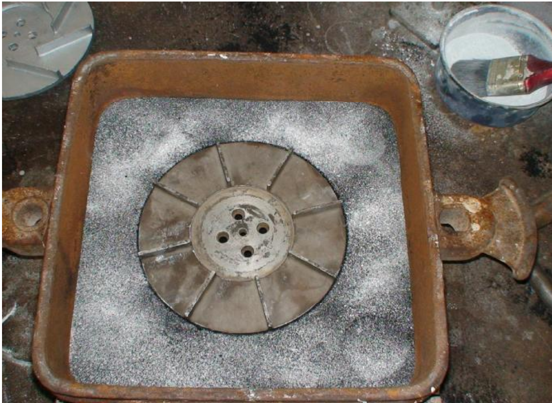
Εικόνα 3.1: Μοντέλο ακτινικής ροής μέσα στην κάσα
