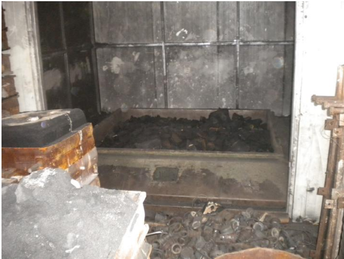
(Εικόνα 4.11 το καμένο χώμα κατά την είσοδο του στο κόσκινο)
