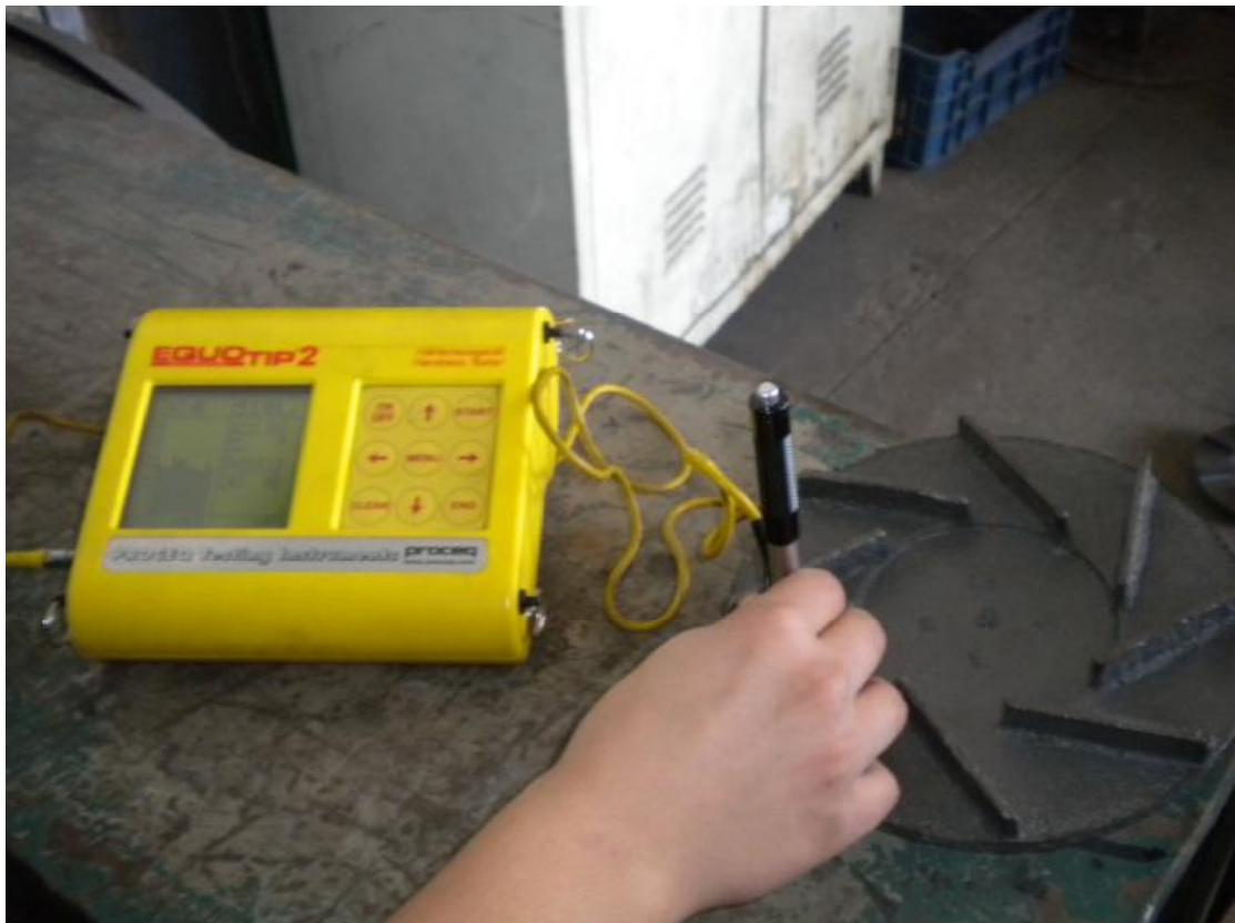
(Εικόνα 7.3: Έλεγχος στην μπροστινή όψη της ππερωτής)
