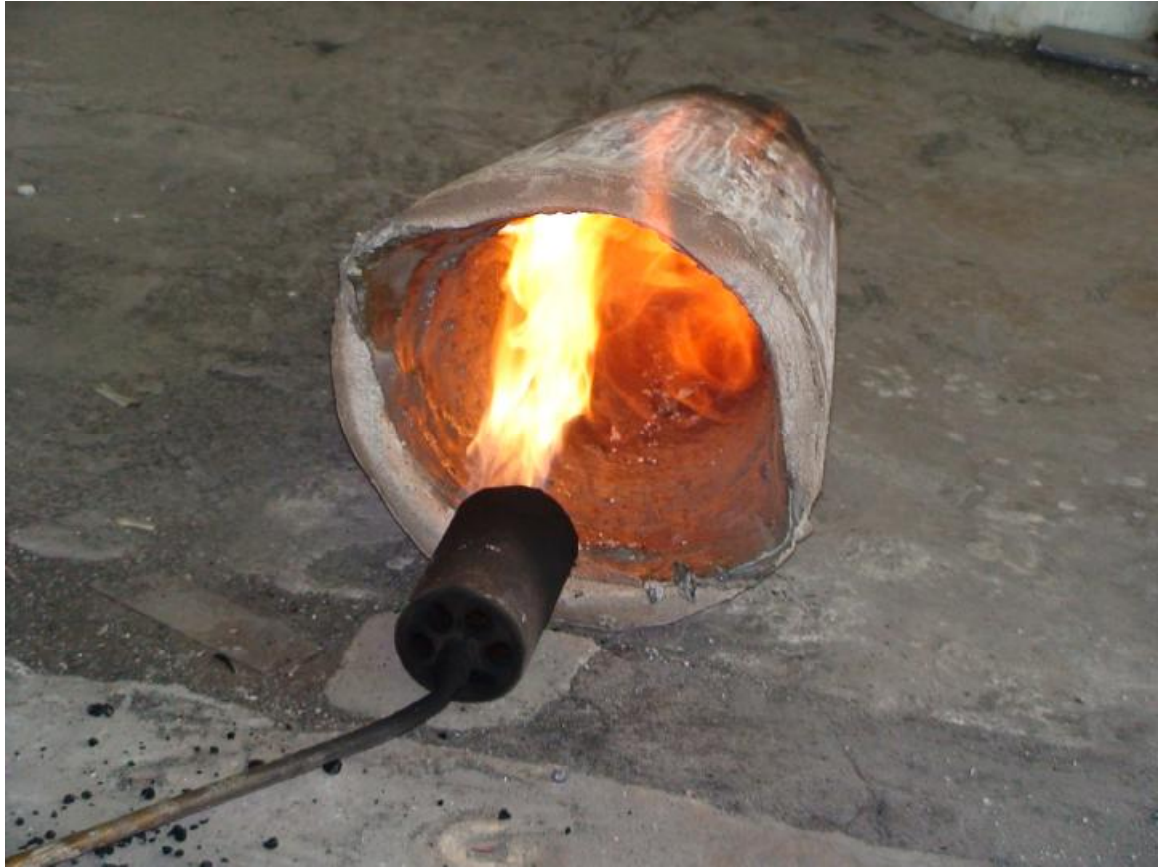
(Εικόνα 4.3 ζέσταμα του χωνιού)
