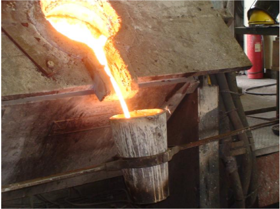
(Εικόνα 4.8 το μέταλλο καθώς μπαίνει στο χωνί)
