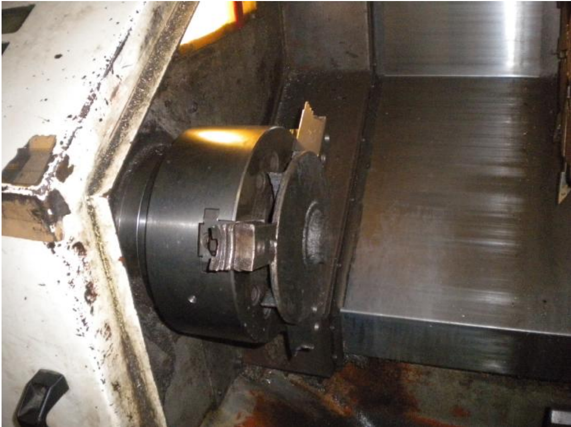
(Εικόνα 5.2 Η πτερωτή δεμένη στο τσοκ του τόνου)
