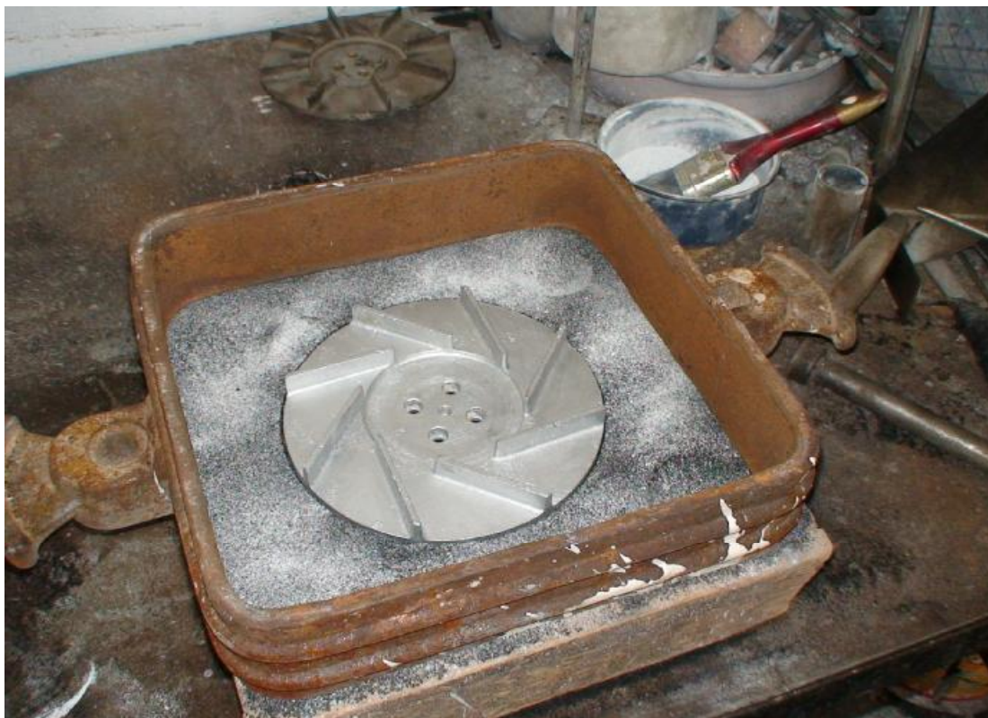
Εικόνα3.2: Μοντέλο φυγοκεντρικής ροής μέσα στην κάσα
