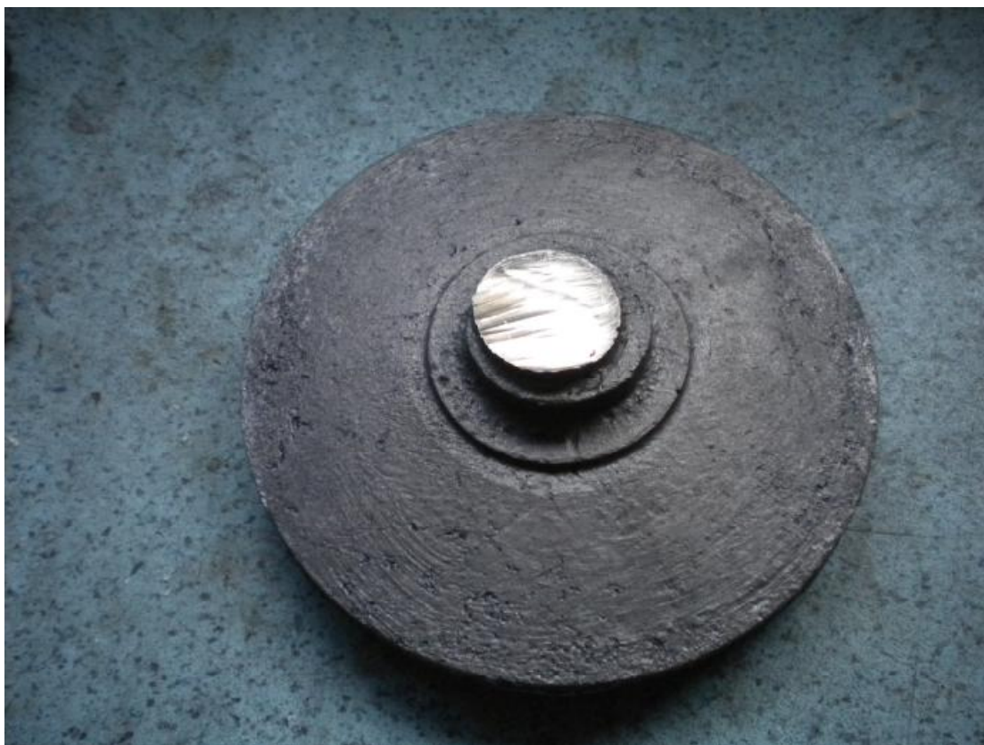
(Εικόνα 5.1: πτερωτή μετά από την κοπή με οξυγονόασετυλίνη)
