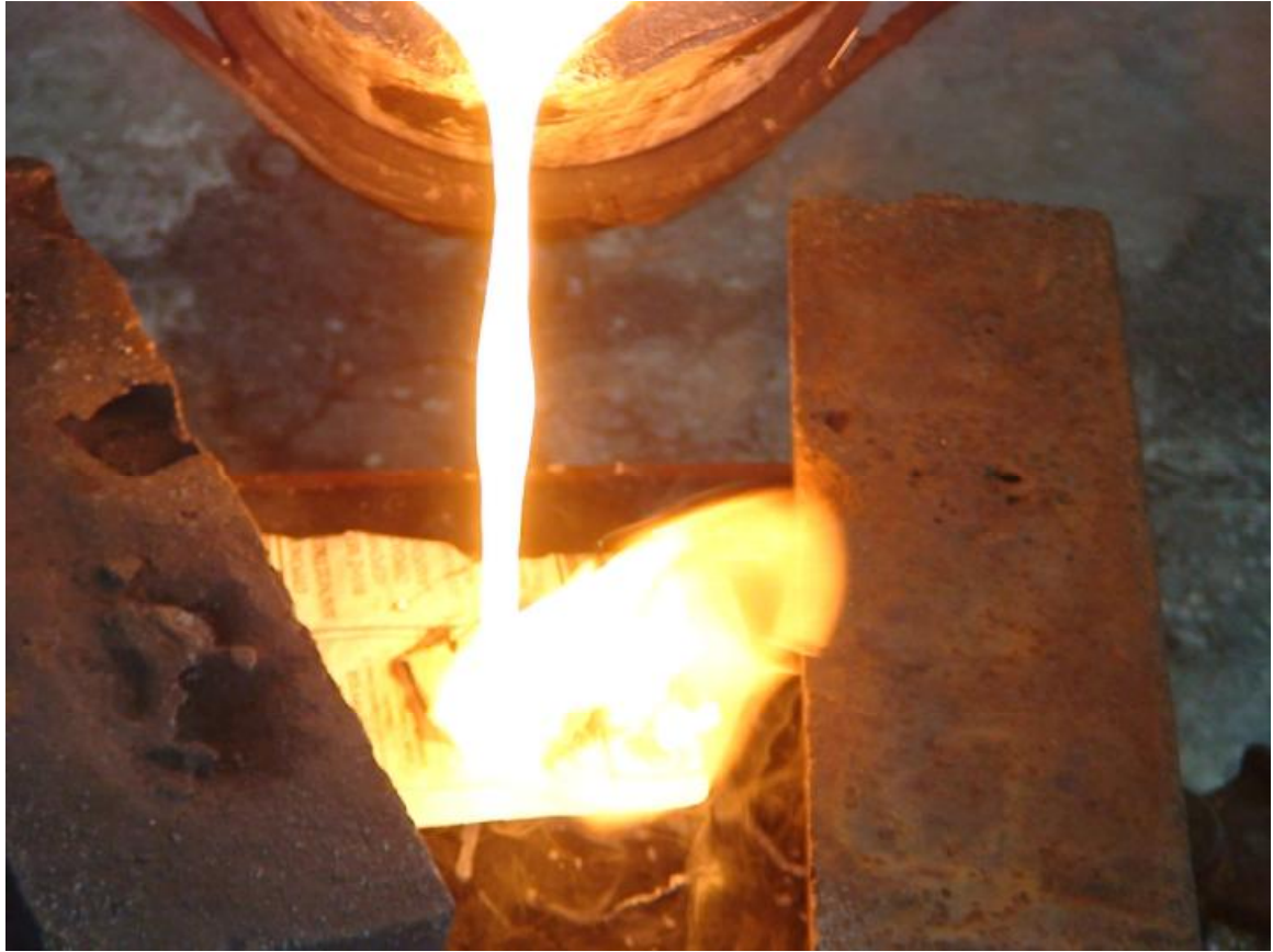
(Εικόνα 4.9 η χύτευση μίας περωτής)
