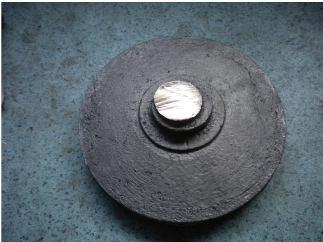
(Εικόνα 5.5: Πτερωτή πριν από την κατεργασία στον τόρνο)
