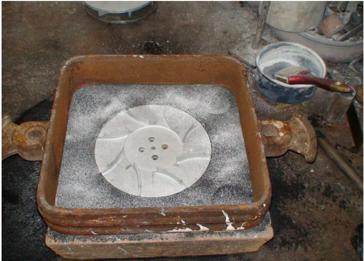
Εικόνα 3.3: Μοντέλο μικτής ροής μέσα στην κάσα
