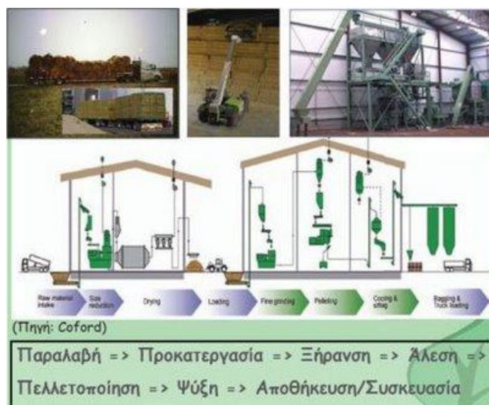
Εικόνα 6.32: Διαδικασία παραγωγής pellets (γραμμή παραγωγής)
