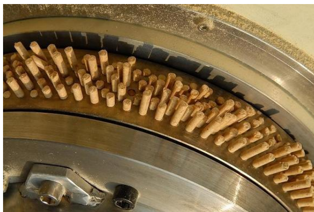
Εικόνα 6.36: Ομοιόμορφη παραγωγή κομματιών πέλλετς κοινής διαμέτρου στην πρέσα.
