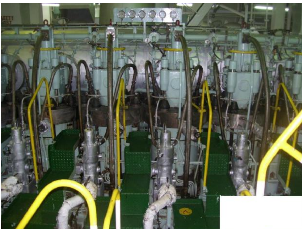
ΕΙΚΟΝΑ 1: Σύστημα έγχυσης αντλίας πετρελαίου Burmeister & Wain τοποθετημένη στο καράβι HELLAS ENDURANCE
