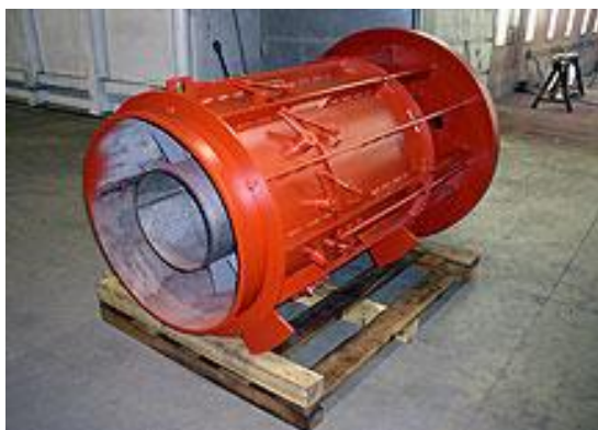
Εικόνα 2.9 Καυστήρας πετρελαίου μεγάλων παροχών καυσίμου
