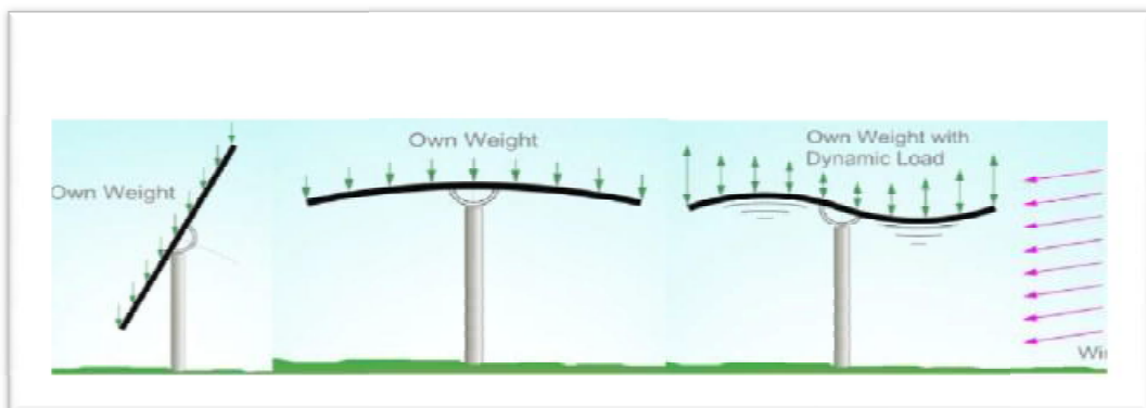
Σχήμα 5.6. Η επίδραση του βάρους των φ/β στοιχείων.
