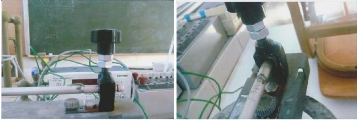
Σχήμα 12: Επιμήκυνση της πειραματικής διάταξη για τον προσδιορισμό του συντελεστή γραμμικής διαστολής ενός υλικού.
