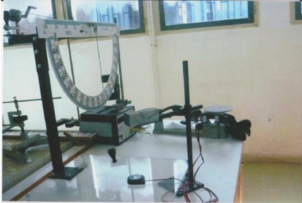
Σχήμα 19: Πειραματική Διάταξη για τη μελέτη των ελεύθερων ταλαντώσεων του απλού εκκρεμούς
