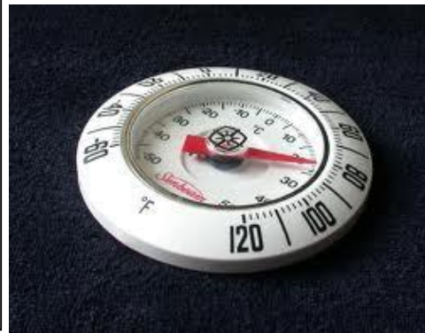
Σχήμα 10 : (α) Αρχή λειτουργίας διμεταλλικού θερμομέτρου (β) διμεταλλικό θερμοόμετρο
