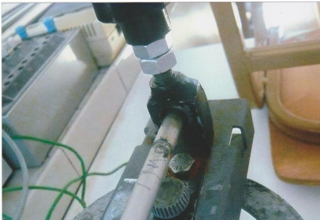
Σχήμα 1: Μετατροπές στην πειραματική διάταξη μελέτης της γραμμικής διαστολής μεταλλικών στερεών.
