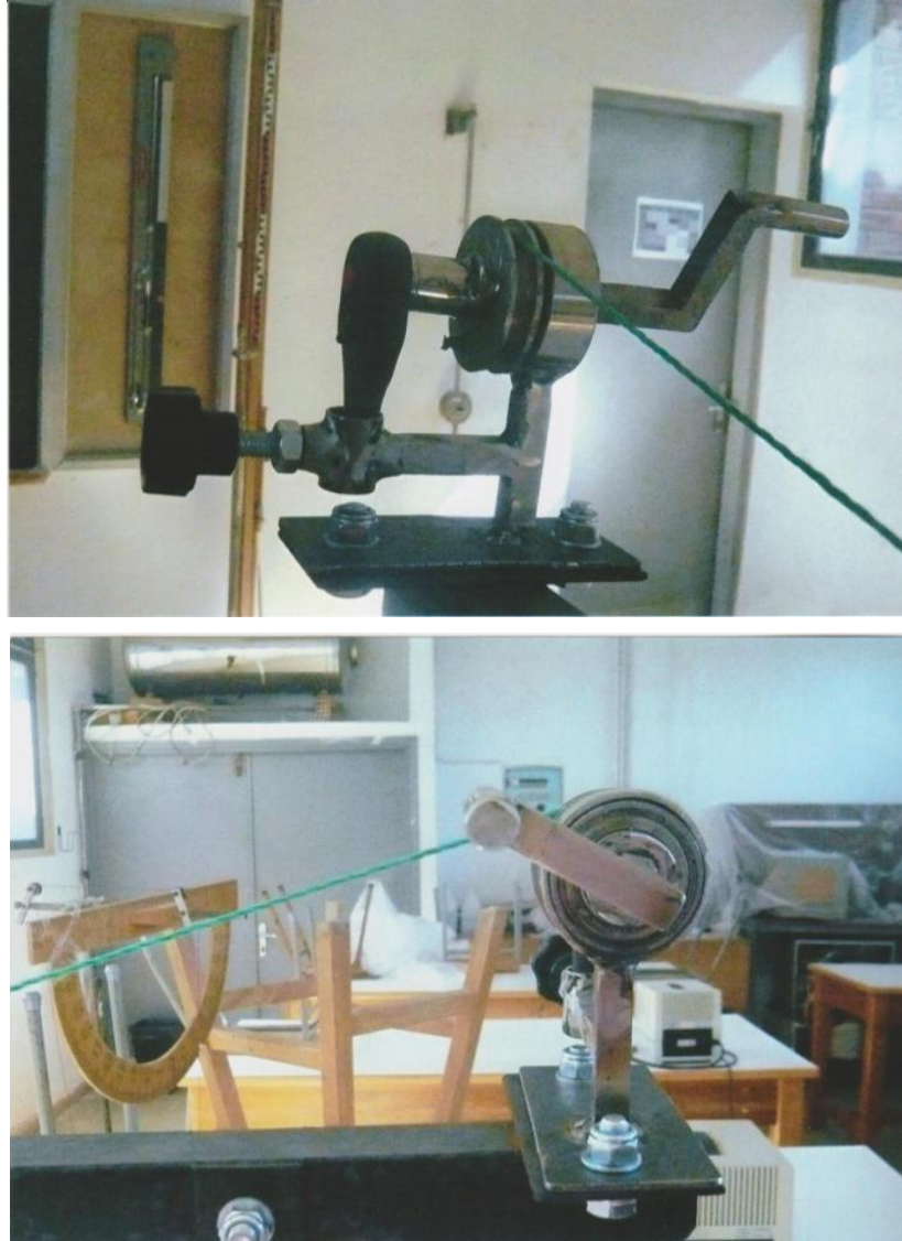
Σχήμα 4: Μηχανισμός τύλιξης του νήματος του εκκρεμούς.
