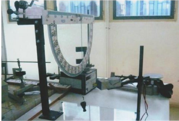
Σχήμα 21: Επαγωγικό προσεγγίσεως για τη μέτρηση των ελεύθερων ταλαντώσεων του απλού εκκρεμούς
