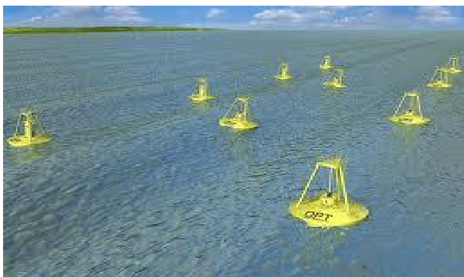
Εικόνα 21: Σημειακοί απορροφητήρες ως συλλέκτες κυματικής ενέργειας για την παραγωγή ηλεκτρικής ενέργειας [35].
