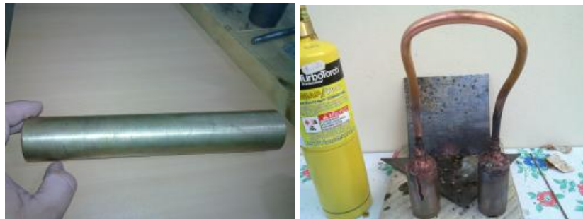
Εικόνα 6.1.1 : Φάσεις κατασκευής Κυλίνδρων
