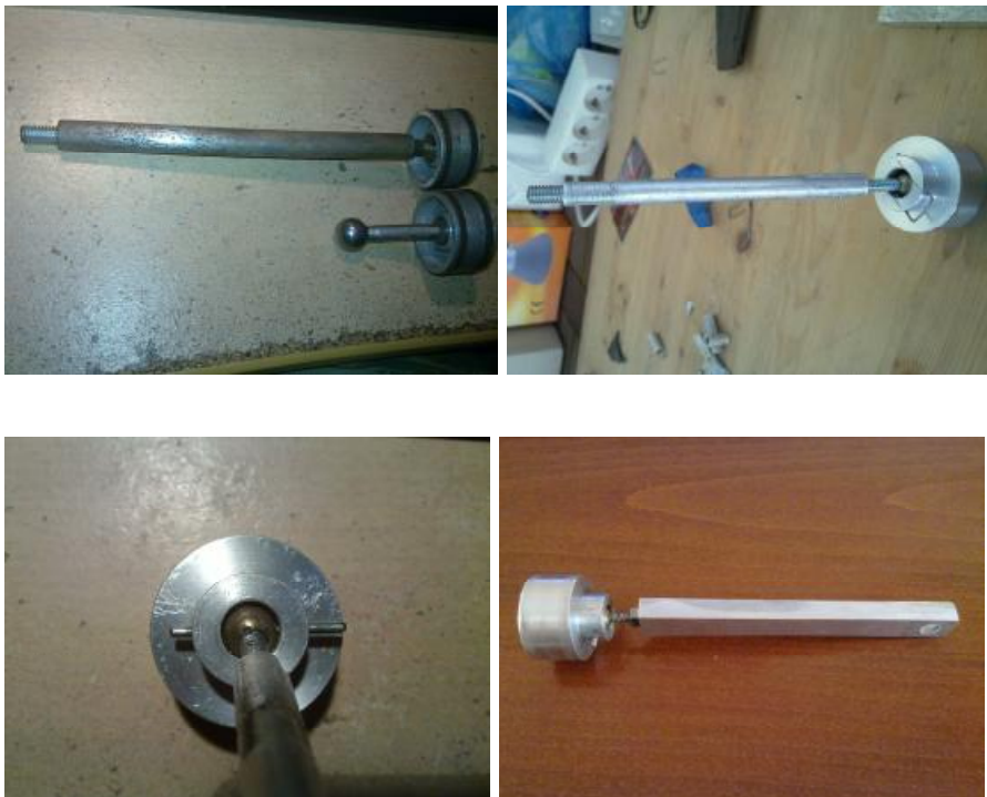
Εικόνα 6.3.1 : Φάσεις κατασκευής Ωστηρίων
