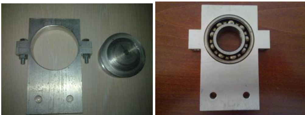
Εικόνα 6.5.2 : Βάσεις στήριξης στροφαλοφόρου.
