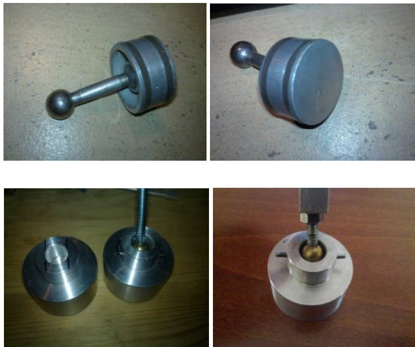
Εικόνα 6.2.1 : Φάσεις κατασκευής Εμβόλων
