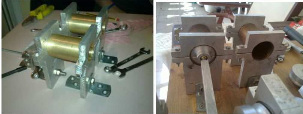
Εικόνα 6.5.1 : Βάσεις στήριξης κυλίνδρων
