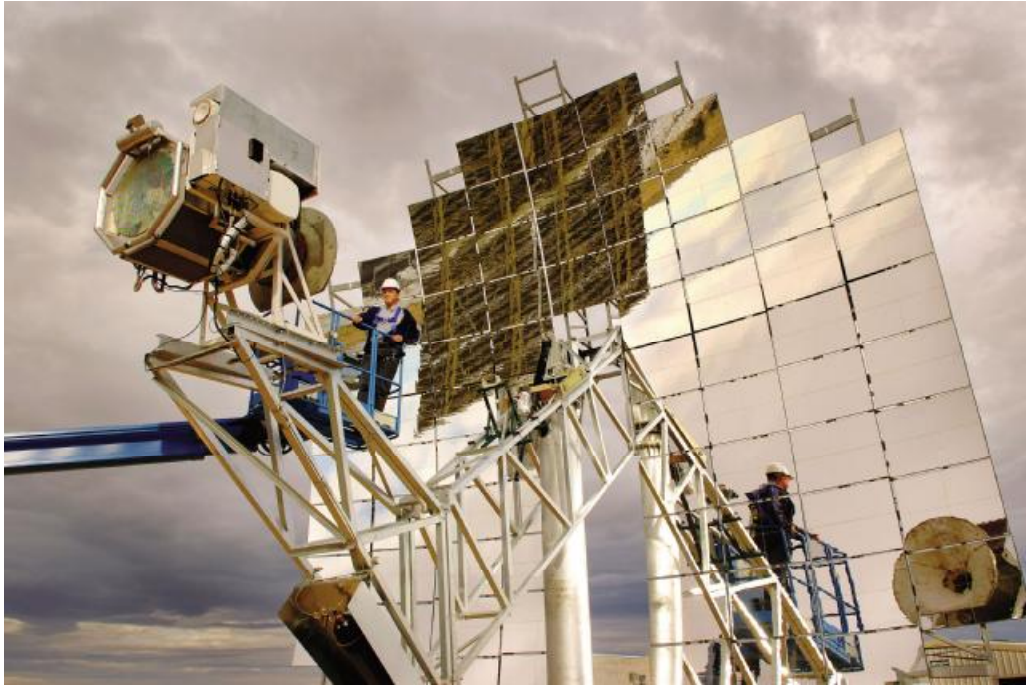
Εικόνα 4.2.3.1 : Μηχανή Stirling με συγκεντρωτικά κάτοπτρα
