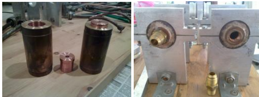
Εικόνα 6.1.2 : Φάσεις κατασκευής Κυλίνδρων
