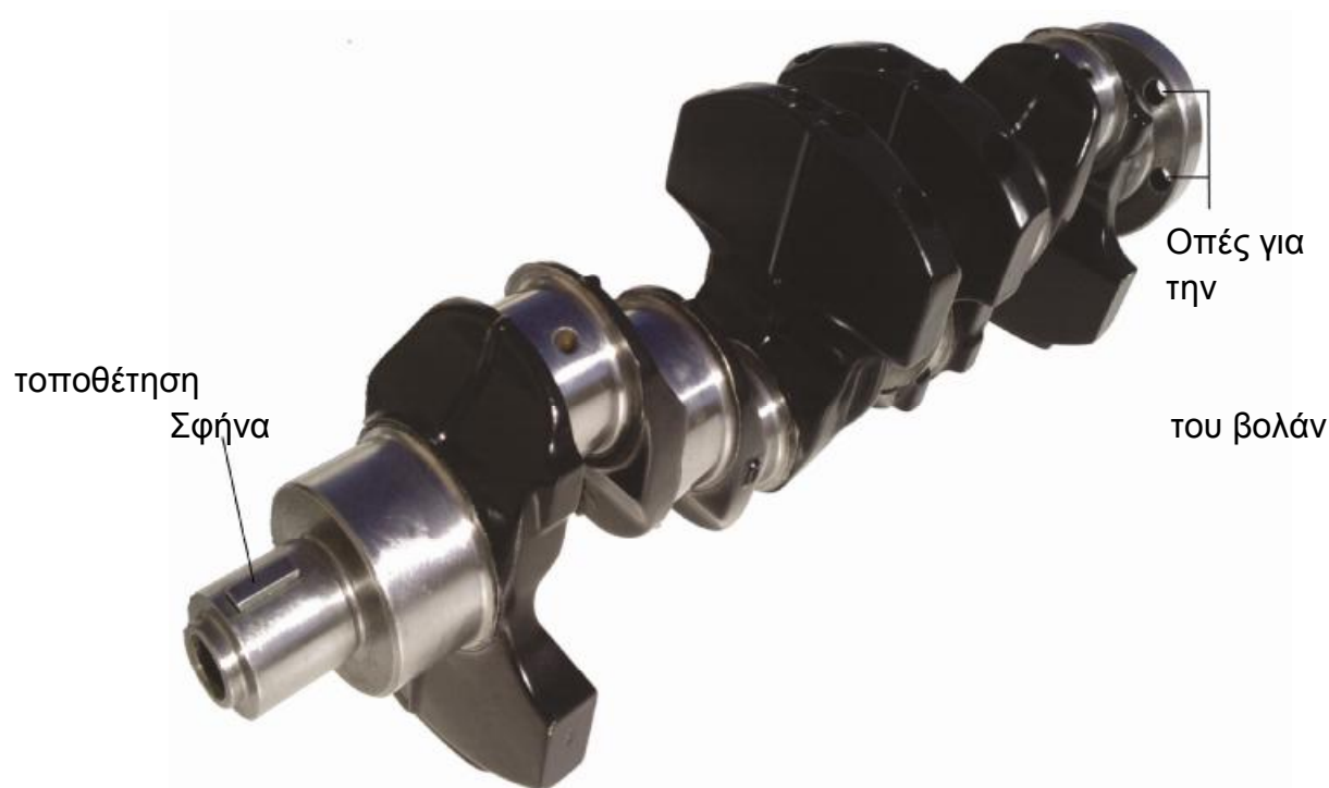
Εικόνα 13.4 : Ανακατασκευασμένος Στροφαλοφόρος του κινητήρα Ε10
