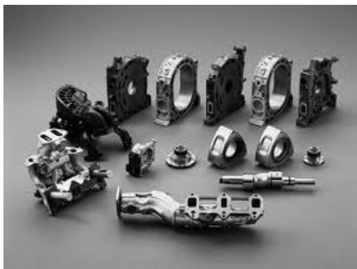
Εικόνα 8.7 : Εξαρτήματα ενός κινητήρας wankel. Σε σύγκριση με τον τετράχρονο βλέπουμε το πόσο λιγότερα εξαρτήματα απαιτούνται
