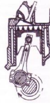
Σχήμα 12.2 : Διαδρομή συμπίεσεως(ο στρόφαλος σπρώχνει το πιστόνι)
