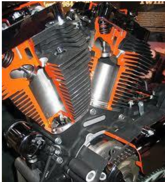
Εικόνα 8.9 : Παράδειγμα αερόψυκτου κινητήρα. Εδώ διακρίνουμε τις ψήκτρες
