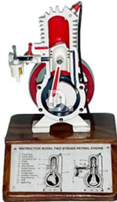
Εικόνα 8.5 : Δίχρονος κινητήρας σε τομή
