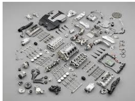
Εικόνα 8.8 : Εξαρτήματα ενός τετράχρονου κινητήρα
