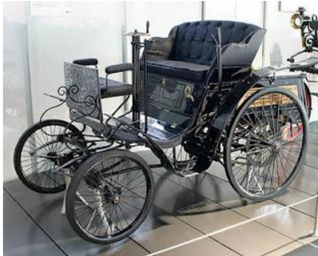
Εικόνα 8.2 : Από τα πρώτα αυτοκίνητα παραγωγής με κινητήρα εσωτερικής καύσης
