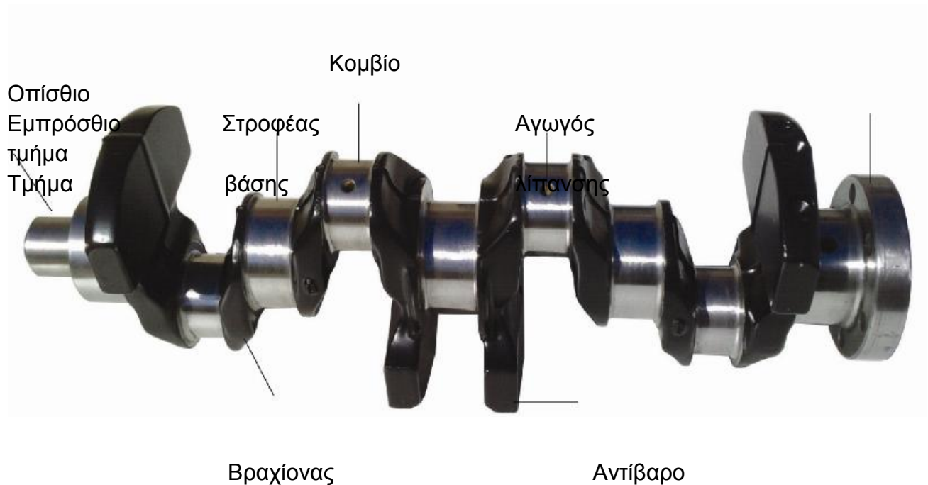
Εικόνα 13.1 : Ονοματολογία του στροφαλοφόρου
