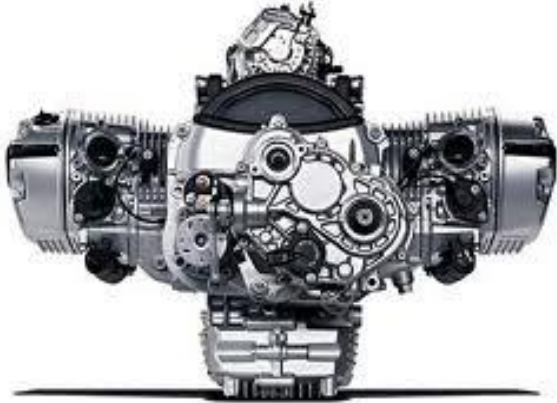
Εικόνα 8.14 : Εξωτερική μορφή του κινητήρα τύπου boxer
