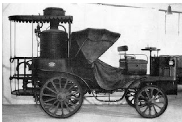
Εικόνα 8.3 : Αυτοκίνητο με μηχανή εξωτερικής καύσης. Αριστερά διακρίνεται ο λέβητας όπου γίνεται η καύση
