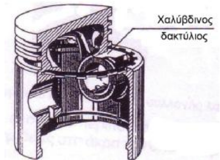
Σχήμα 11.5 : Έμβολο με προσαρμοσμένο δακτύλιο
