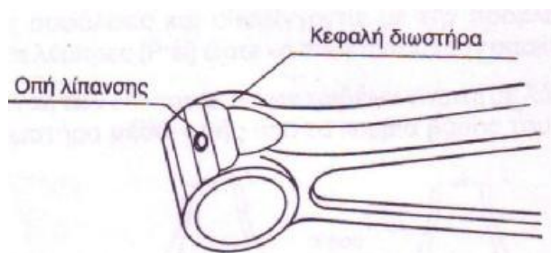
Σχήμα 11.16 : Οπή που εκτοξεύει λαδι στο εμβολο
