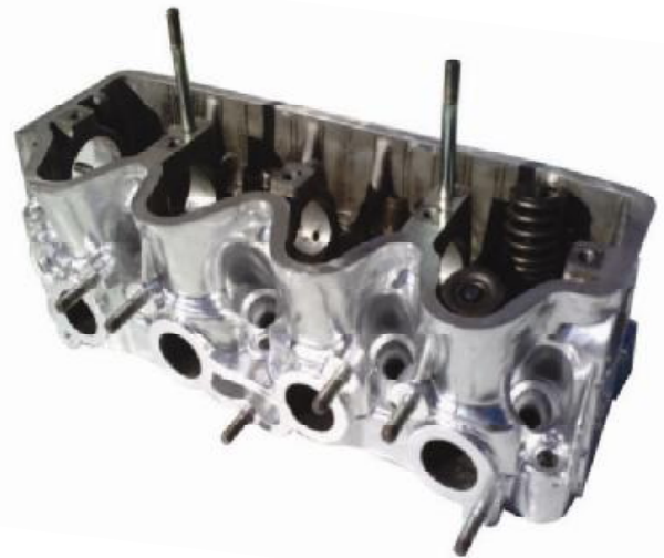
Εικόνα 8.20 : Η κεφαλή βαμμένη με κατάλληλο χρώμα που αντέχει στις υψηλές θερμοκρασίες
