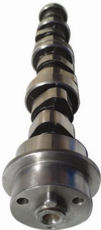
Εικόνα 10.4 : Η εμφάνιση του εκκεντροφόρου αποκαταστάθηκε. Στο εσωτερικό της κεφαλής διακρινουμε τους ενσωματωμένους τριβείς
