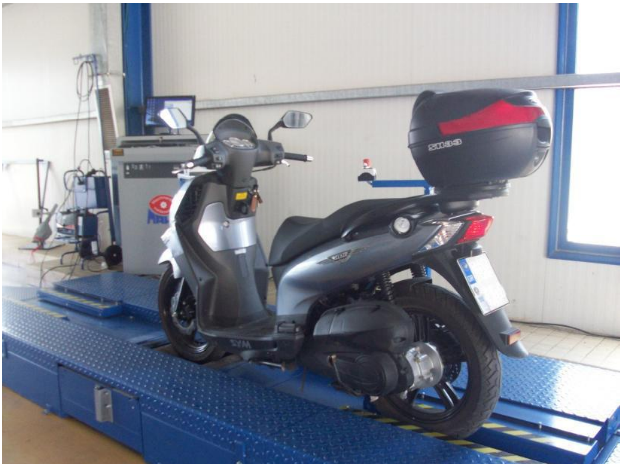
Εικόνα 5.3 Μηχανισμός ελέγχου για μοτοσικλέτες
