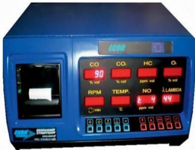
Εικόνα 4.14 Μηχάνημα Ελέγχου καυσαερίων
