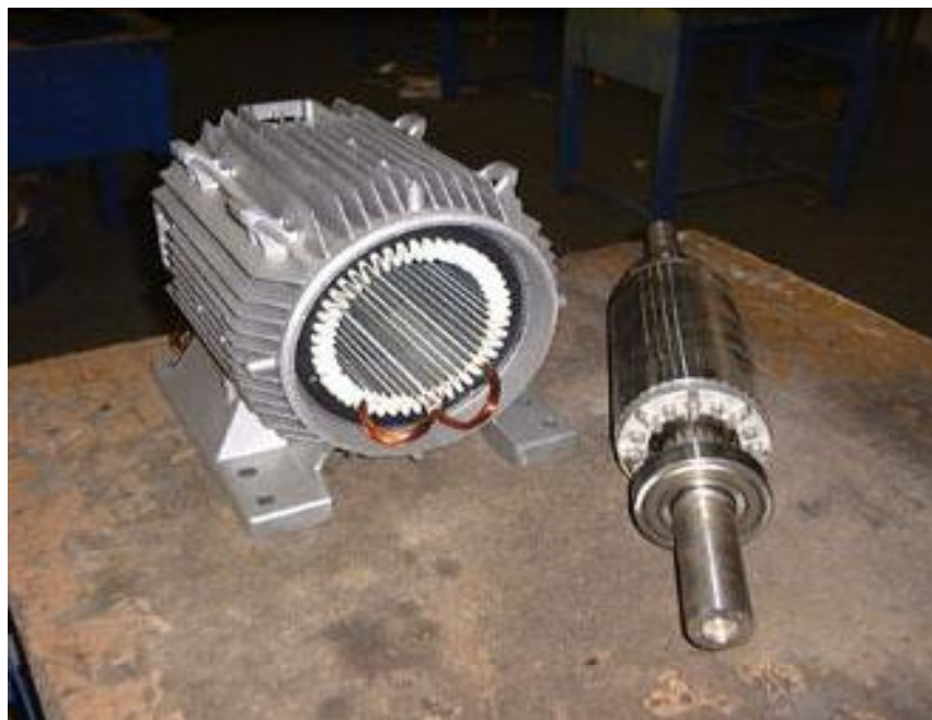
Εικόνα 1.13 Εσωτερικό ασύγχρονου κινητήρα στην οποία διακρίνονται όλα τα δομικά του στοιχεία
