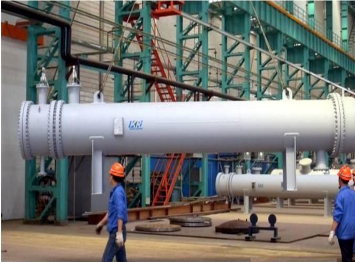
Εικόνα 3.22:Εναλλάκτης θερμότητας ( www.bartassociates.com )
