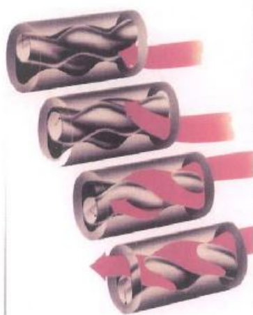
Εικόνα 3.11:Λειτουργία Κοχλιωτής Αντλίας (Σ.Κοκκώνης,Π.Νικολού,2005)
