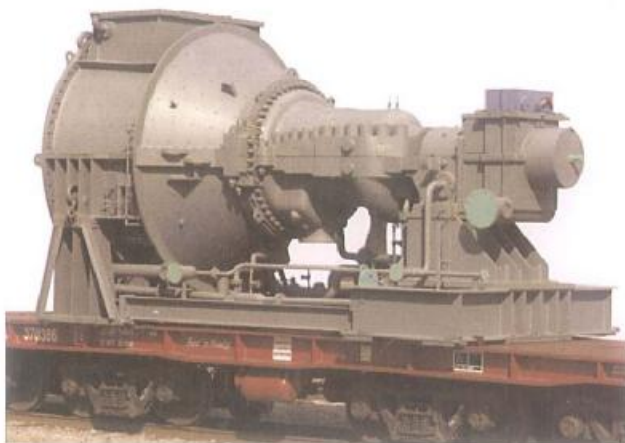
Ατμοστρόβιλος έτοιμος για μεταφορά
