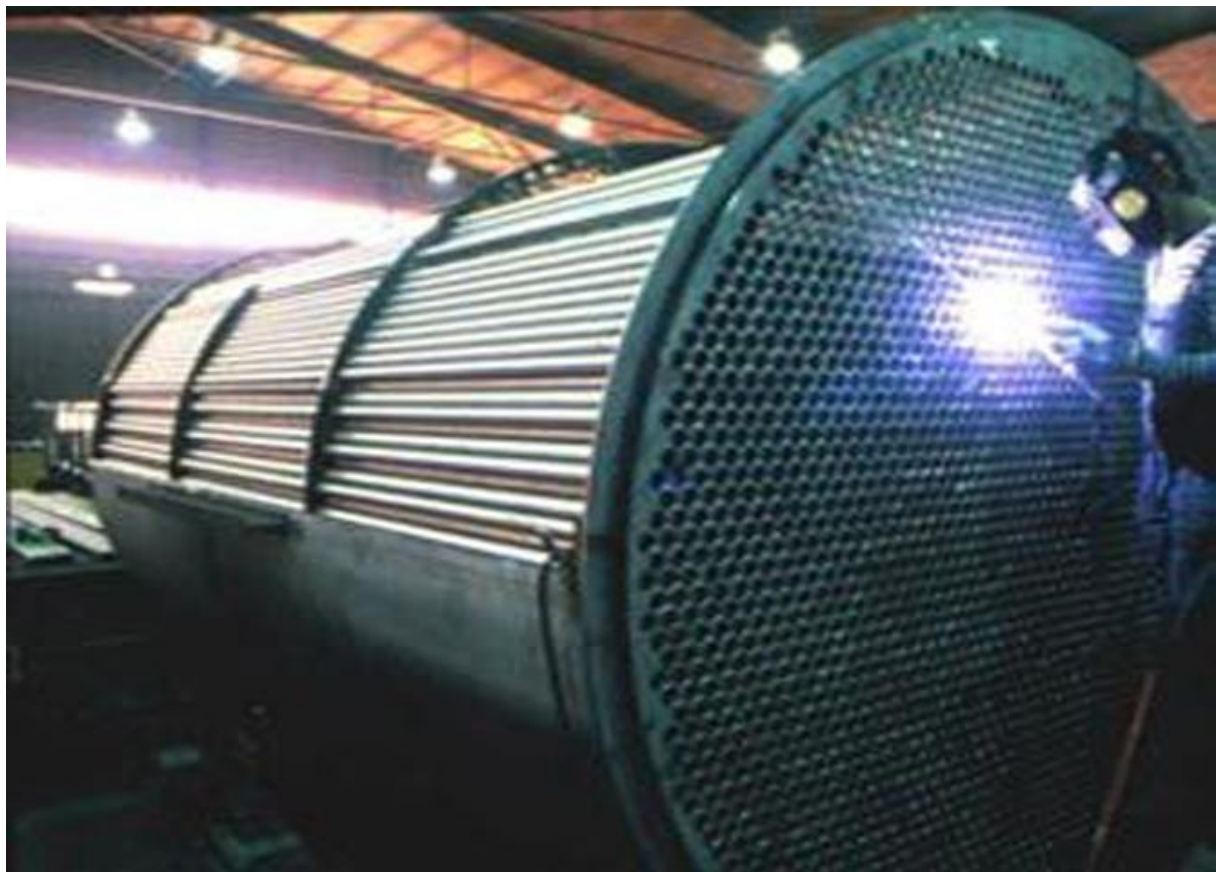
Εικόνα 3.23 : Εναλλακτης με κέλυφος και αυλούς ( www.bartassociates.com )
