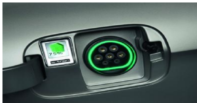
Εικόνα 3.3 : Υποδοχή τροφοδότησης από δίκτυο 220 V
