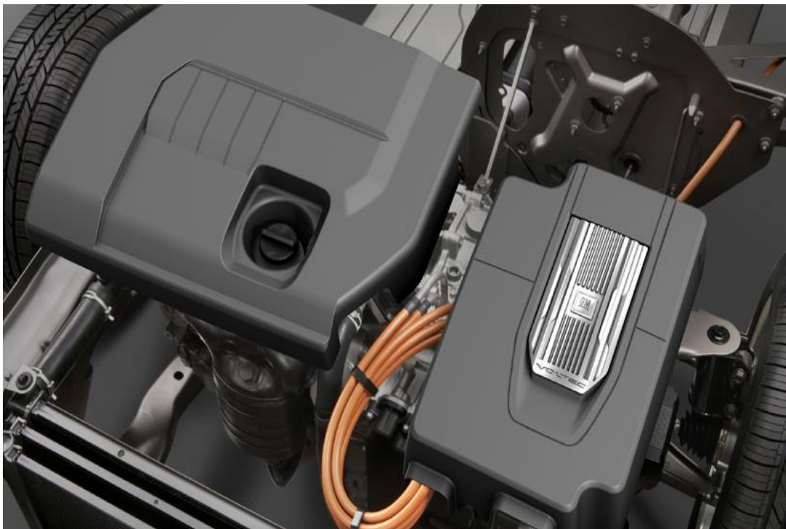
Εικόνα 4.1 :Βενζινοκινητήρας και Ηλεκτροκινητήρας σε παράλληλη σύνδεση
