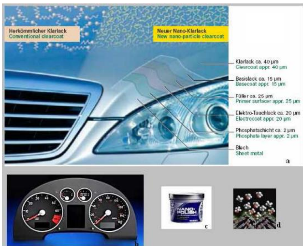
Σχήμα 3.9: (a) Βαφή από νανοςύνθετα που χρησιμοποιεί η Mercedes, (b) Πλαστικά στο εσωτερικό του αυτοκινήτου κατασκευασμένα από PP ενισχυμένο με PS για την βελτίωση της επιφάνειας και την αποφυγή γρατζουνιών, (c) Στιλβωτικό από νανούλικά που προστατεύει την επιφάνεια του αυτοκινήτου και (d) 3D απεικόνιση καυσίμου DIESEL με προσμίξεις οξειδίων μετάλλων.
