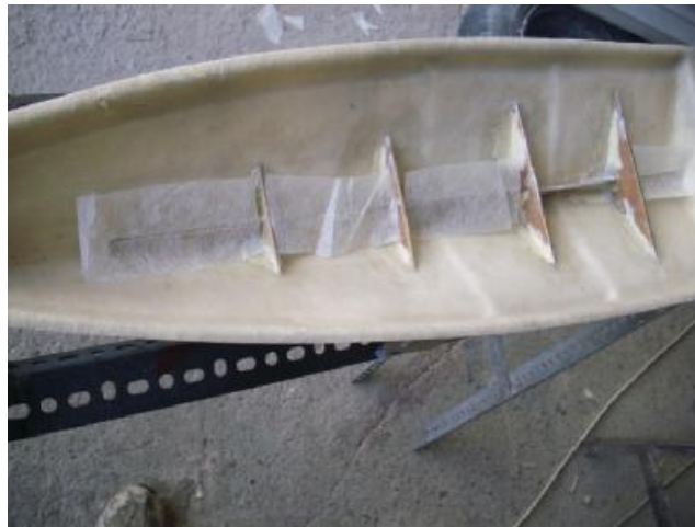
Κατασκευή εσωτερικών ενισχύσεων της γάστρας.
