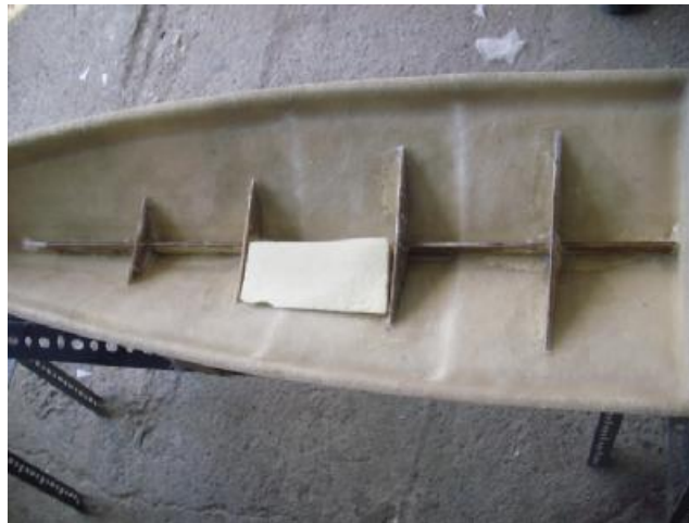
Κατασκευή εσωτερικών ενισχύσεων της γάστρας.
