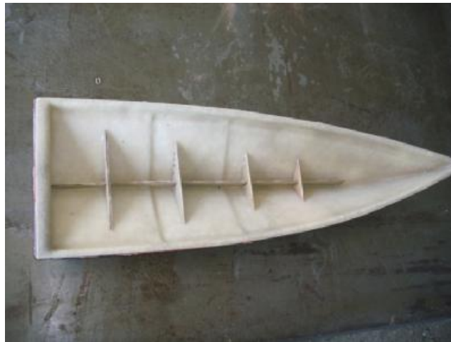
Κατασκευή εσωτερικών ενισχύσεων της γάστρας.
