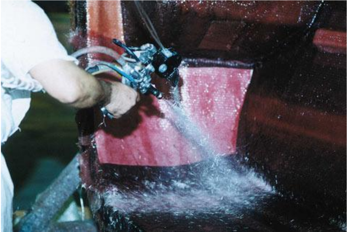
Εικόνα 21: Εκτόξευση πολυεστέρα – υαλονήματος από το chopper spray gun πάνω στο καλούπι
