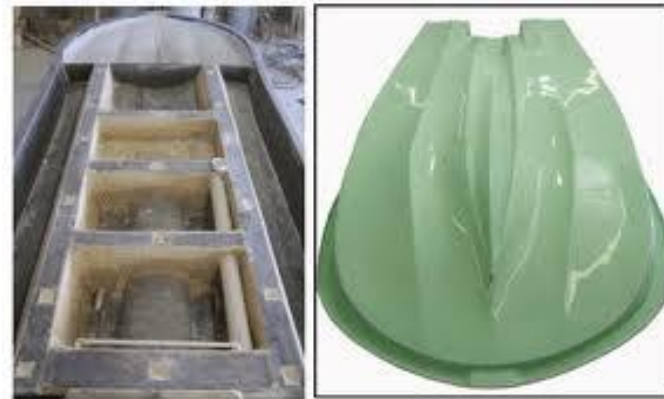
Εικόνα 10: Εσωτερικές ενισχύσεις με αφρό πολυουρεθάνης και κόντρα πλακέ θαλάσσης
