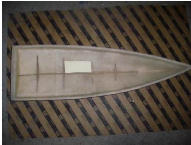
Κατασκευή εσωτερικών ενισχύσεων της γάστρας.
