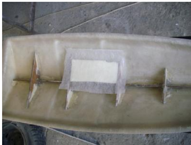
Κατασκευή εσωτερικών ενισχύσεων της γάστρας.
