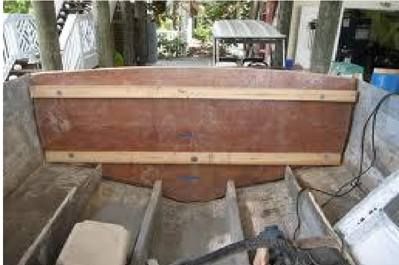
Εικόνα 11: Ενίσχυση από κόντρα πλακέ θαλάσσης στον καθρέφτη του σκάφους
