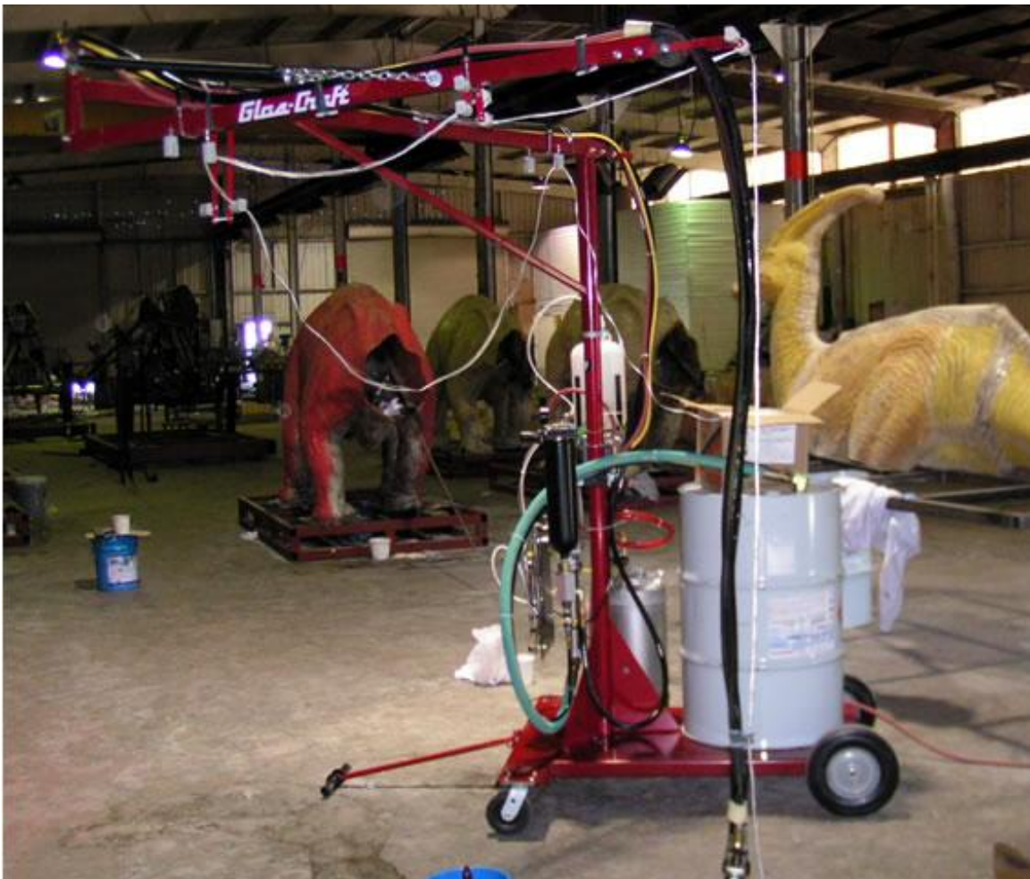
Εικόνα 20: Διάταξη chopper spray gun
