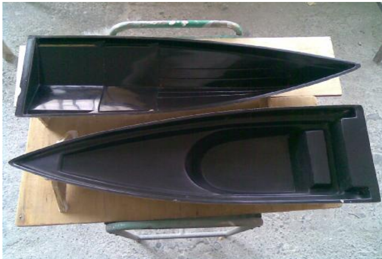
Εικόνα 1: Καλούπια γάστρας και υπερκατασκευής
