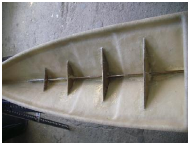
Κατασκευή εσωτερικών ενισχύσεων της γάστρας.
