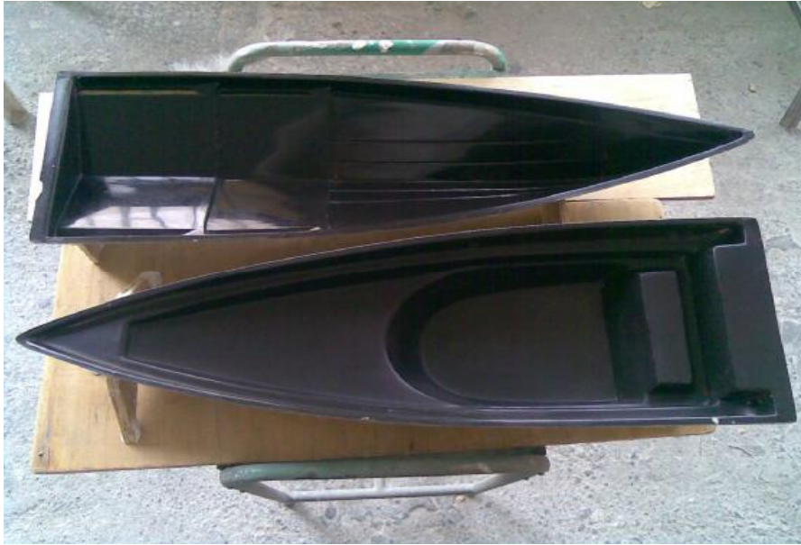
Εικόνα 4: Καλούπια γάστρας και υπερκατασκευής
