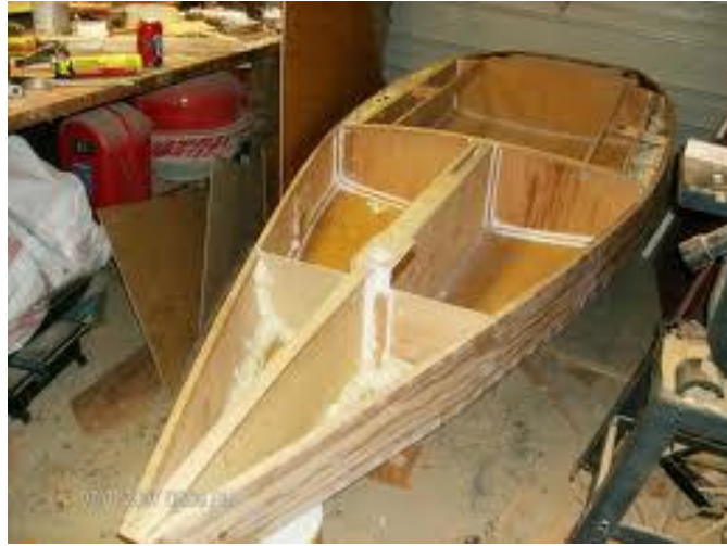
Εικόνα 9: Εσωτερικές ενισχύσεις με αφρό πολυουρεθάνης και κόντρα πλακέ θαλάσσης
