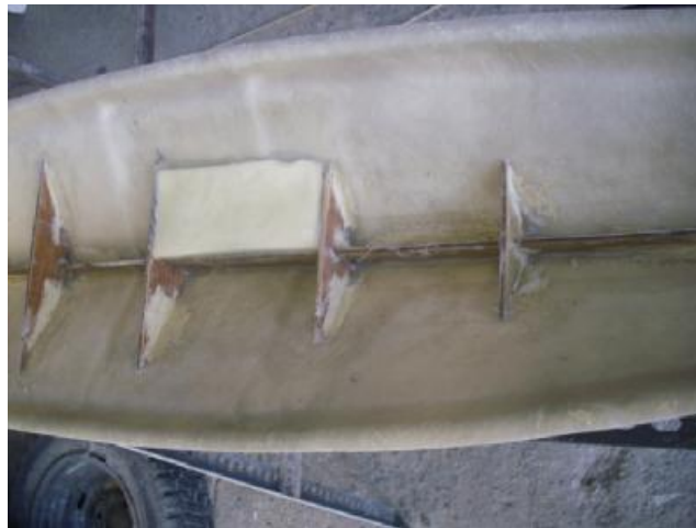
Κατασκευή εσωτερικών ενισχύσεων της γάστρας.
