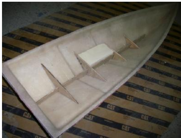
Κατασκευή εσωτερικών ενισχύσεων της γάστρας.
