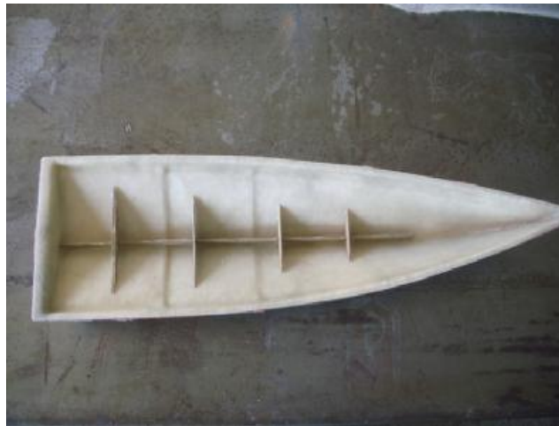
Κατασκευή εσωτερικών ενισχύσεων της γάστρας.
