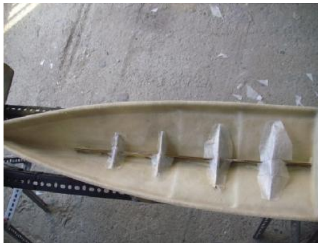
Κατασκευή εσωτερικών ενισχύσεων της γάστρας.
